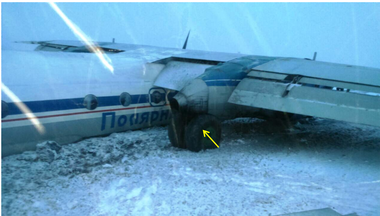
Рис. 13. Складывание правой основной стойки шасси (колёса шасси показаны стрелкой)
