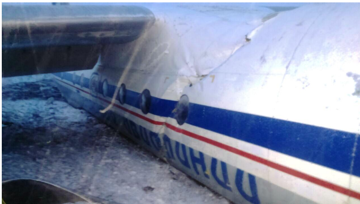
Рис. 15. Деформированный фюзеляж ВС
