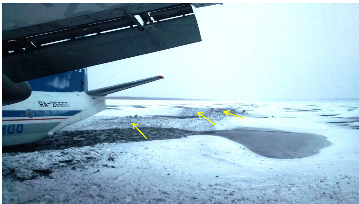
Рис. 12. Следы движения ВС по грунту (показаны стрелками)
