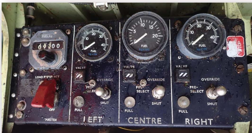
Figura 8 Panel de reaprovisionamiento de combustible
