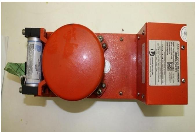
Рисунок 5 Бортовой аварийный звуковой регистратор FA2100 SN000274566
