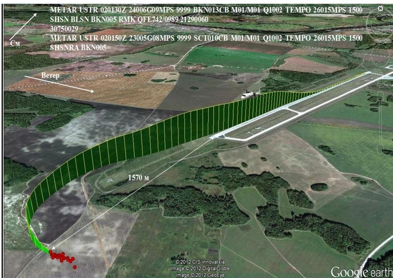
Рисунок 31 Схема движения ВС после взлета
