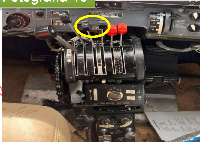
Fotografía 16: Las palancas de hélices full adelante, lo que indica máxima RPM. Fuente: Investigador encargado. Año: 2024
