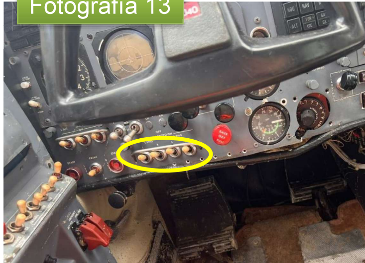
Fotografía 13: Magnetos de ambos motores en la posición ON. Fuente: Investigador encargado. Año: 2024
