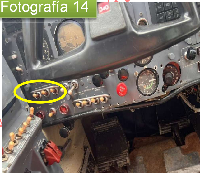
Fotografía 14 Switch de batería y alternadores ON. Fuente: Investigador encargado. Año: 2024
