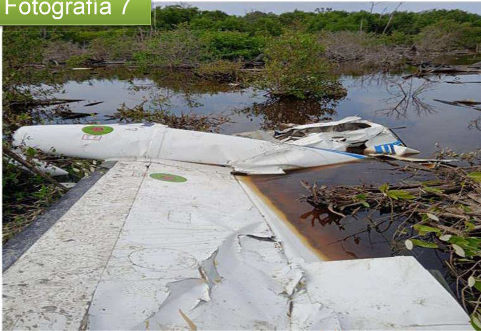
Fotografía 7. Ala derecha y restos de la nariz del avión. YV3112. Fuente: Investigador encargado. Año: 2024
