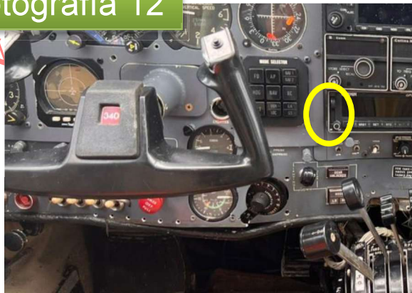
Fotografía 12: Palanca de tren de aterrizaje en la posición UP, lo que indica que el tren estaba arriba Cessna 340A Fuente: Investigador encargado. Año: 2024
