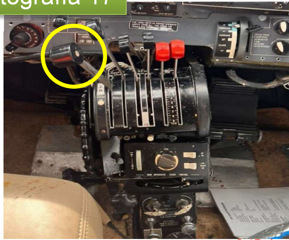
Fotografía 17: Palancas de potencia con leve asimetría, pero ambas full potencia.
