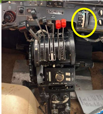
Fotografía 19 Indicación flap 0°. Fuente: Investigador encargado. Año: 2024
