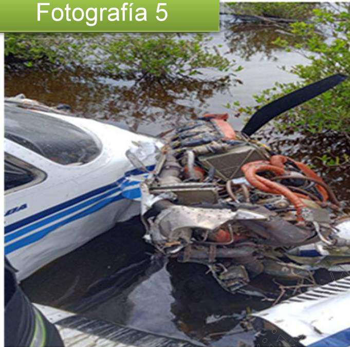
Fotografía 5. Motor Izquierdo, encontrado del lado derecho de la cabina YV3112. Fuente: Investigador encargado. Año: 2024
