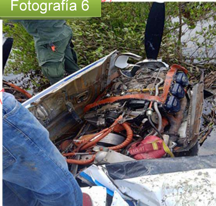
Fotografía 6. Motor derecho, en su posición original YV3112. Fuente: Investigador encargado. Año: 2024
