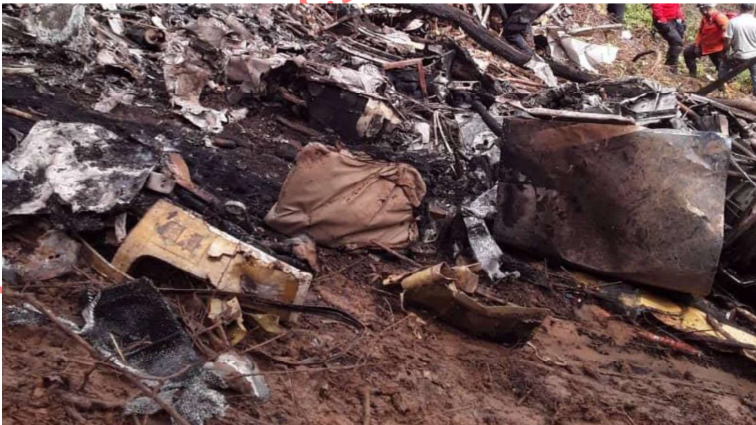
Imagen 36. Restos de la aeronave con evidencia de fuego YV1104 Fuente: Investigador Encargado. Año 2019
