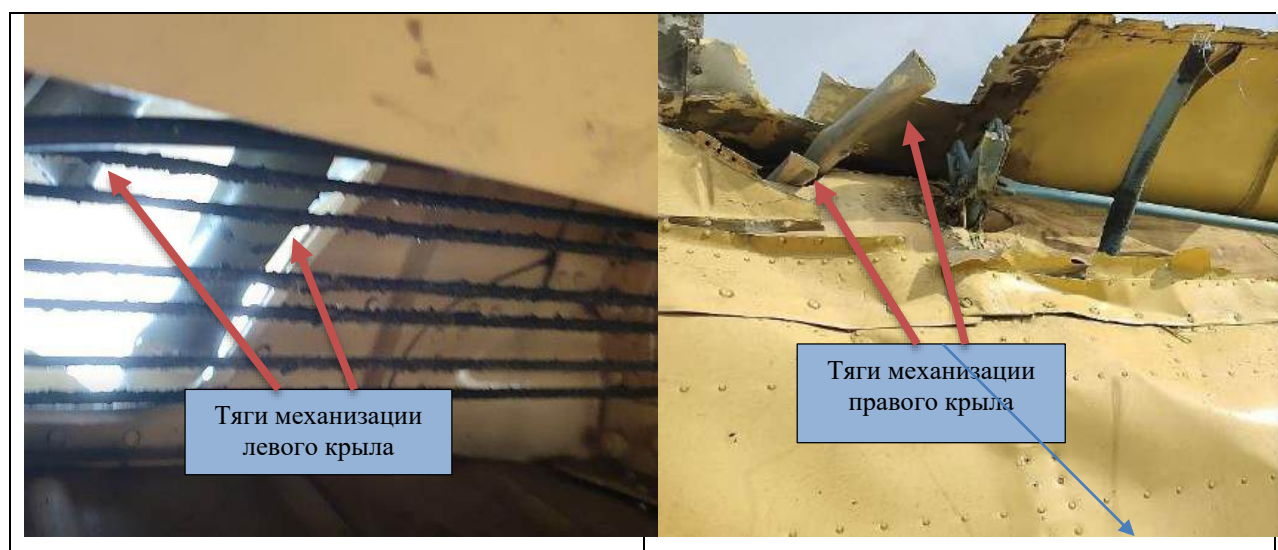
Рис. 11. Разрушения тяг механизации крыла
