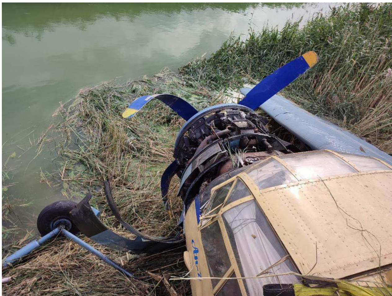
Рис. 14. Вид лопастей ВВ после АП
