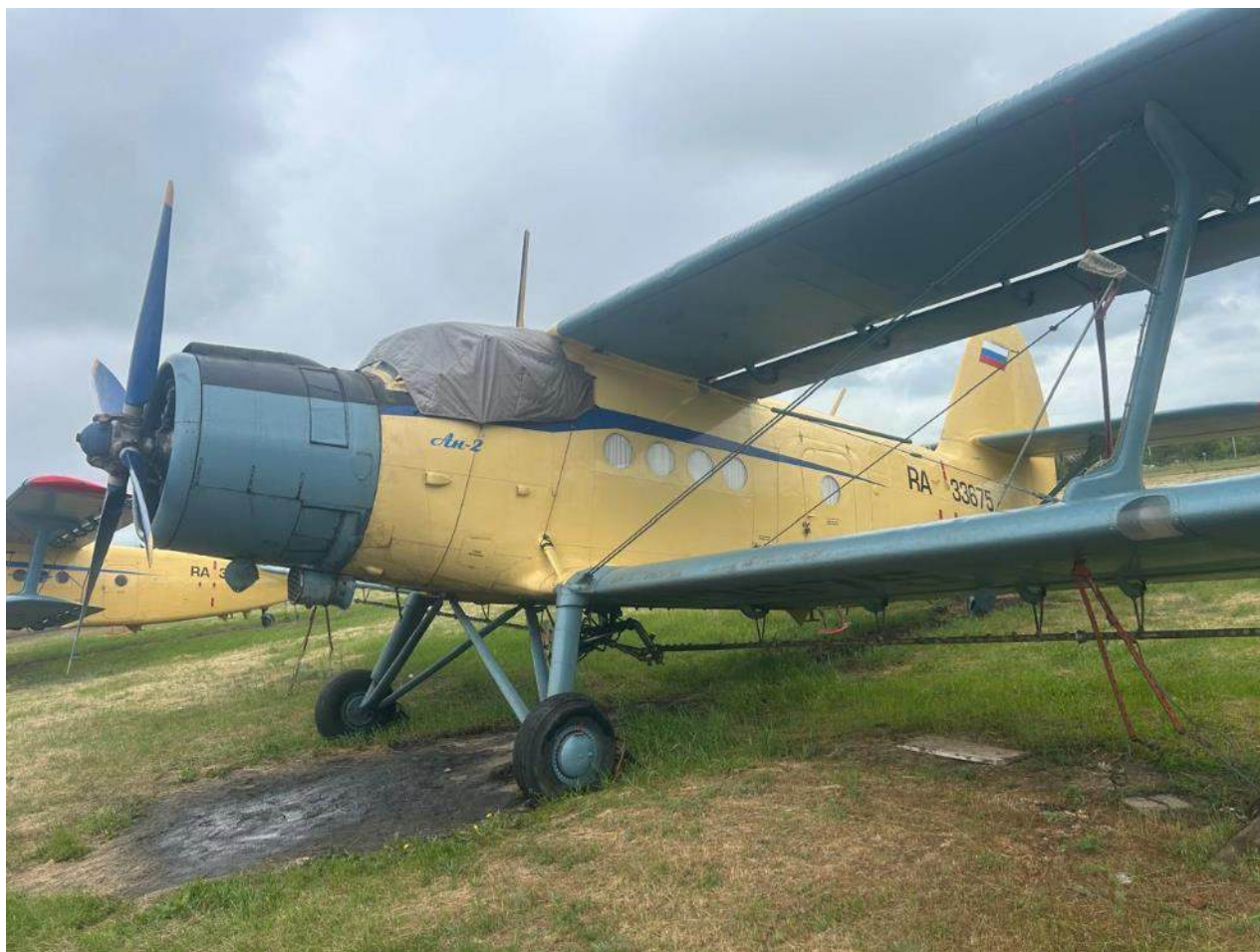
Рис. 5. Вид самолета Ан-2 RA-33675 с сельскохозяйственной аппаратурой
