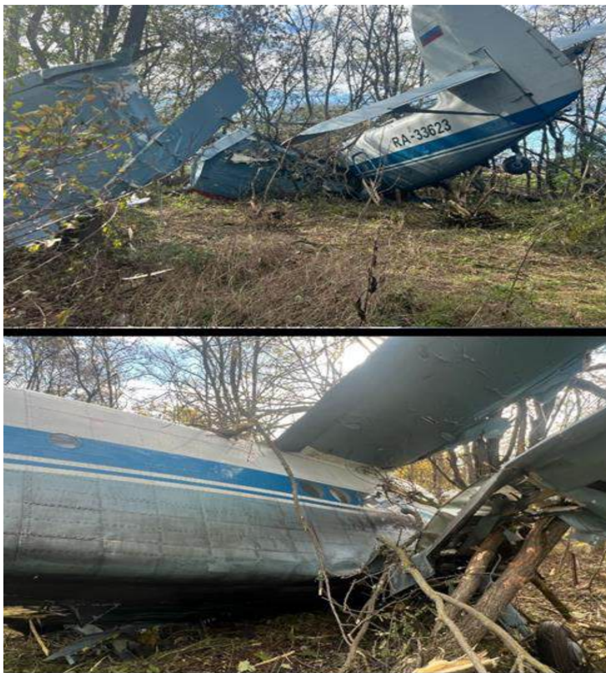
Рис. 3. Повреждения ВС на месте АП
