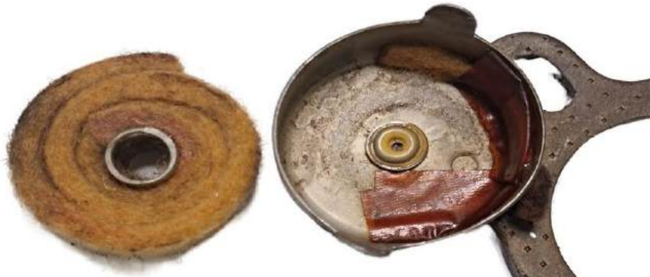
Рис. 8. Вид фитиля и корпуса масленки магнето № 1915201163
