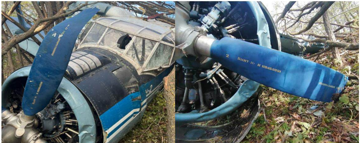
Рис. 4. Повреждения лопастей воздушного винта
