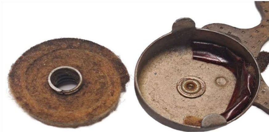
Рис. 9. Вид фитиля и корпуса масленки магнето № 0680100791
