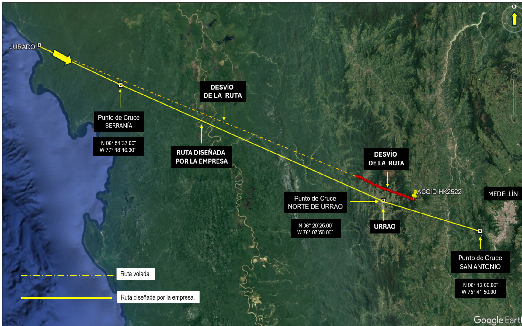
Imagen 2. Graficación del desvío de la ruta diseñada en el Plan de vuelo operacional.
