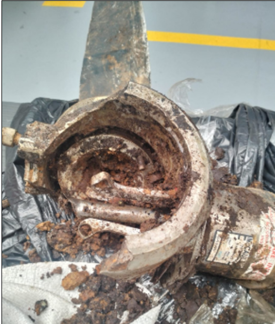
Fotografía 9. Núcleo de la Hélice del motor No.2
