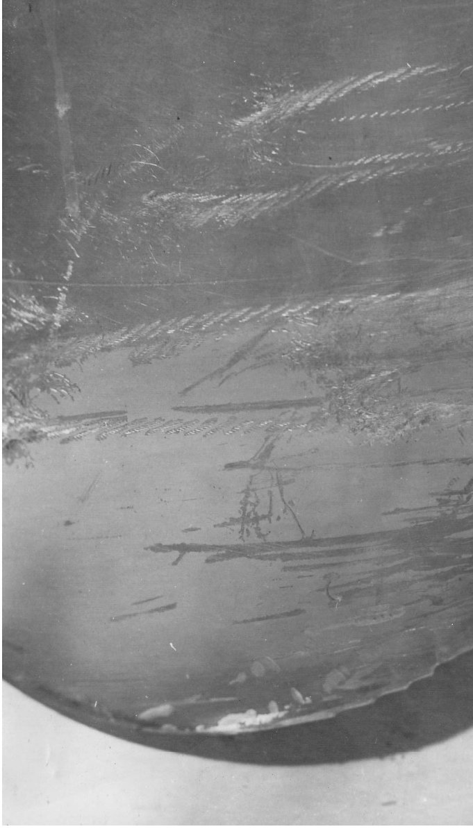
élice droite . Pale n°3 Traces des cables de commande sur l'extrados de la pale
