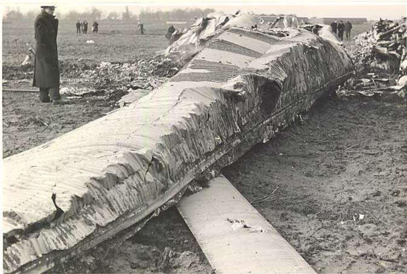
13.- Aplatissement du bord d'attaque de coque droite.
