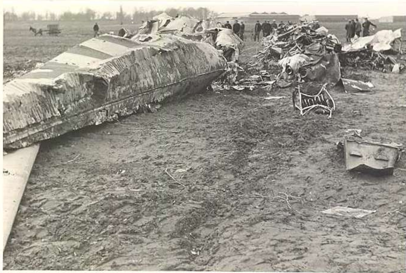
11. Empreinte du bord d'attaque de l'aile droite.
