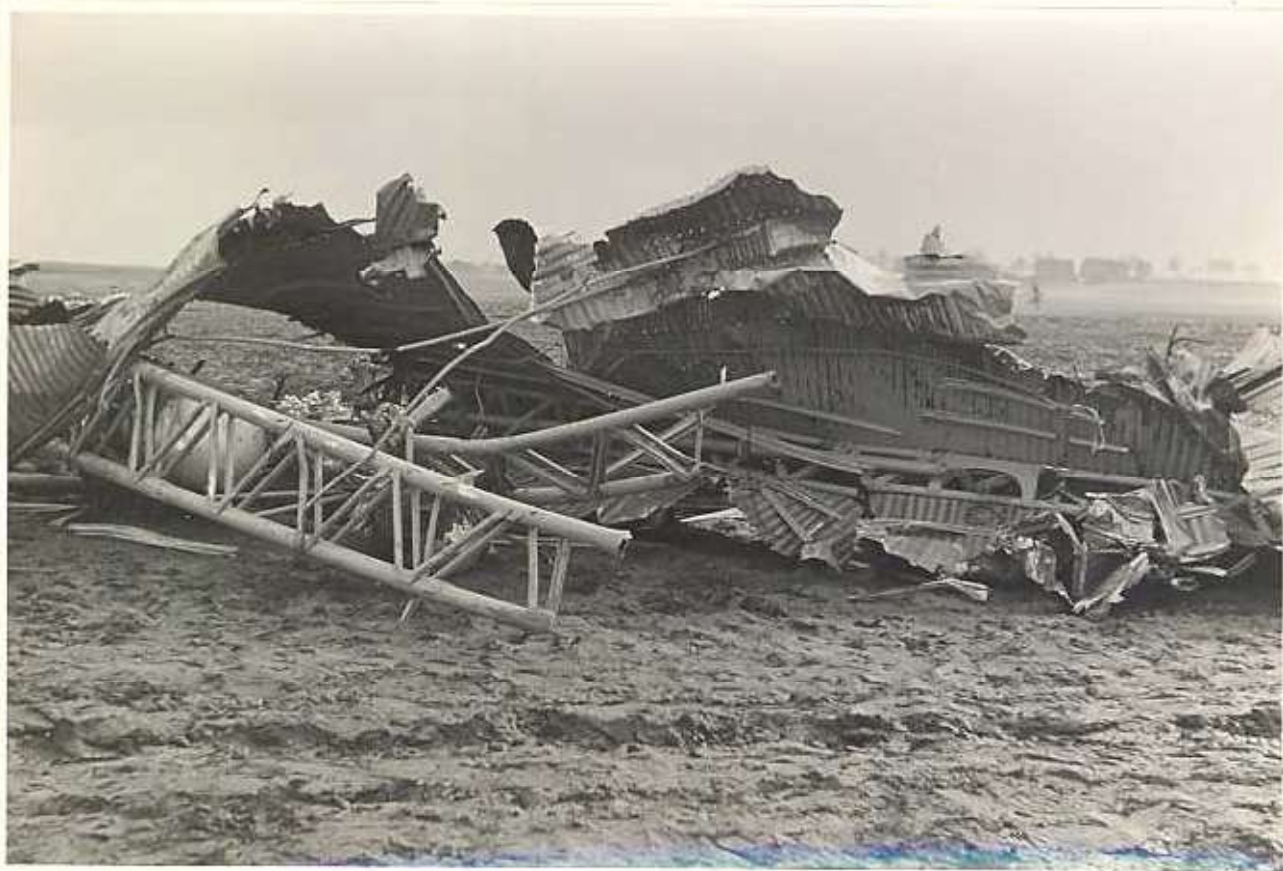
9 - Débris des longerons et du revêtement de l'aile gauche.
