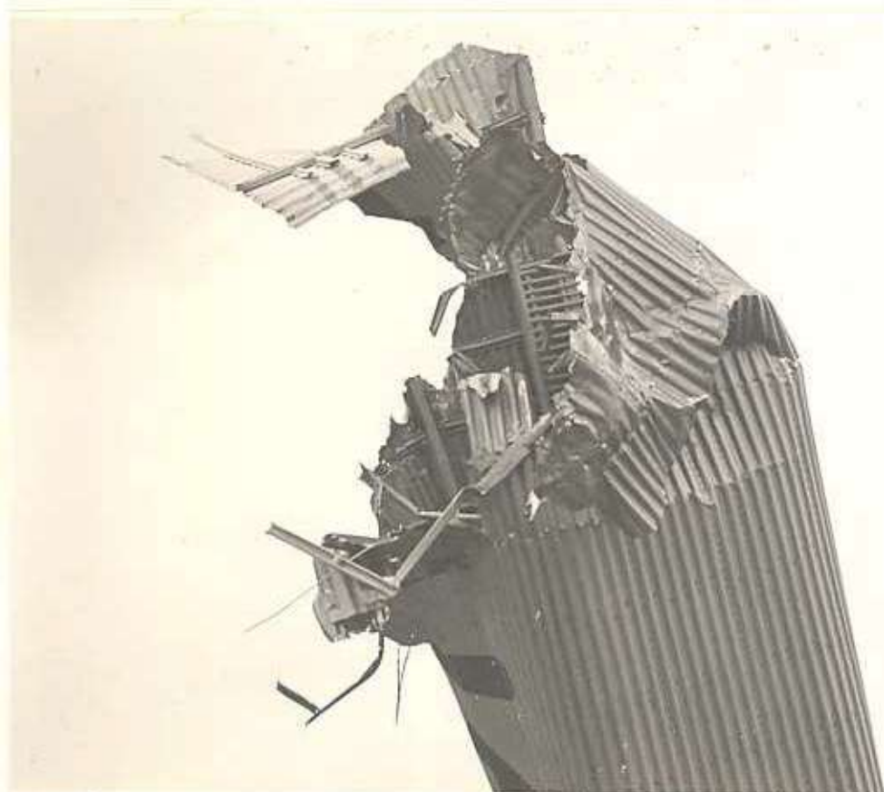
18. - Vue montrant la rupture par flexion du fuselage.
