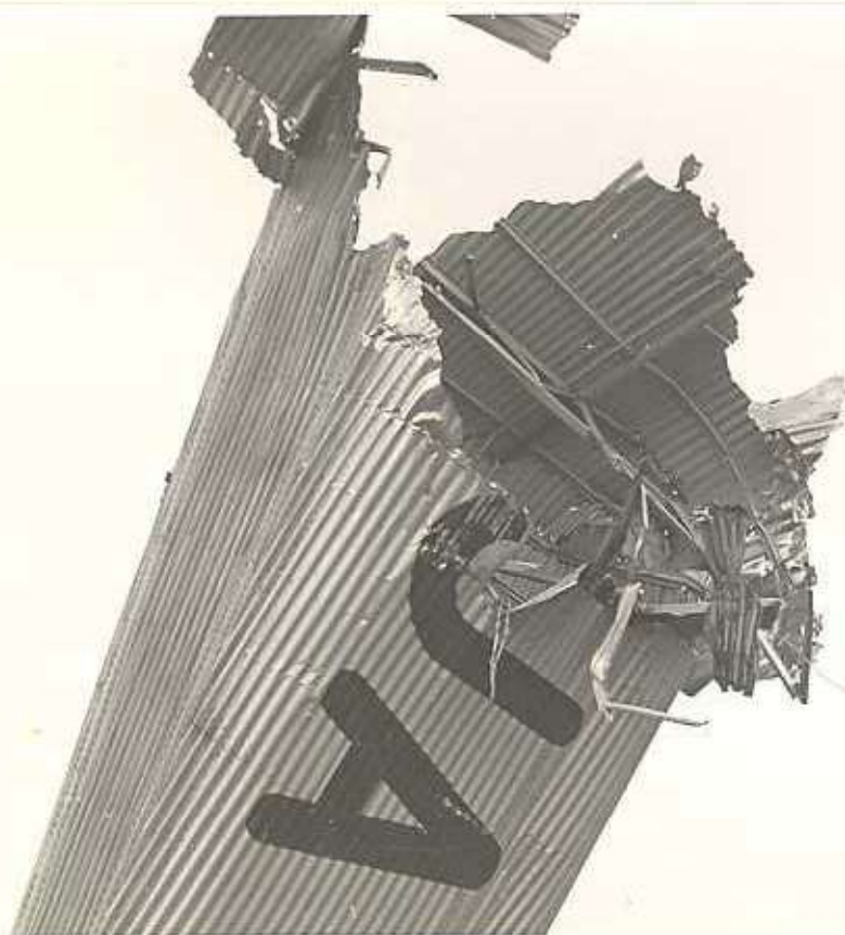
17- Cassure de la partie arrière du fuselage
