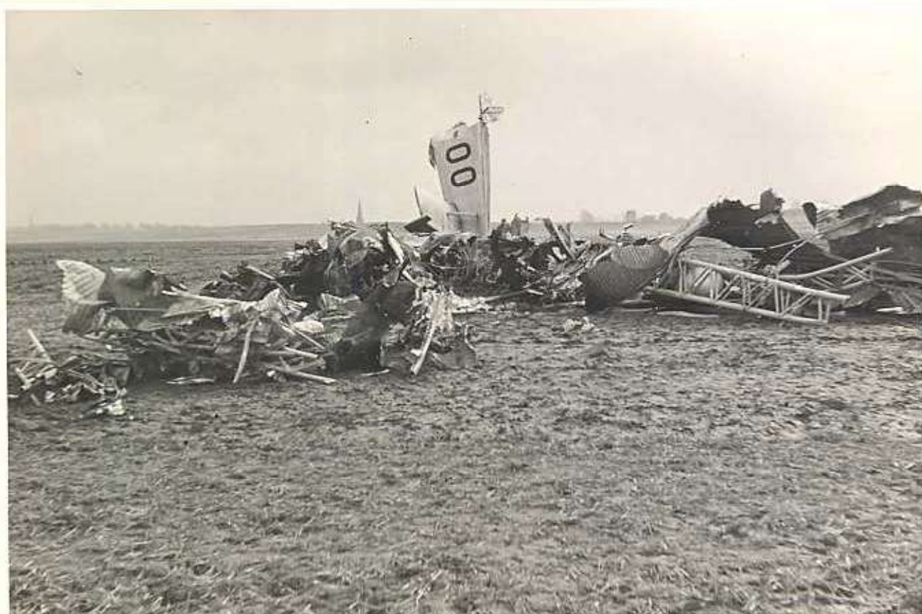
8. Débris de l'aile gauche: à gauche, ceux de l'extrémité détachés par le 1 er contact avec le sol (photo 7); à droite, la partie de l'aile restée adhérente au fuselage.
