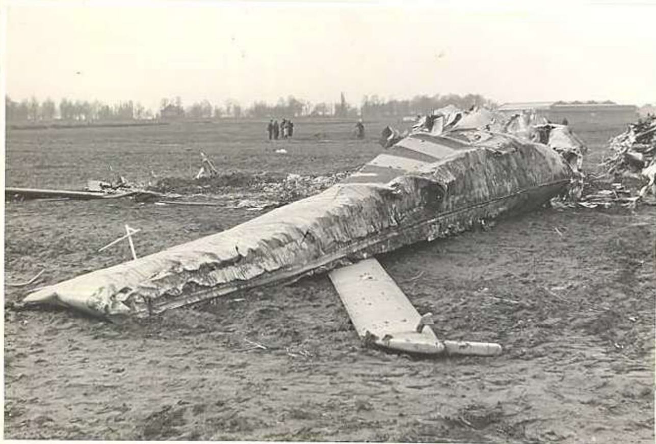
R - Vue de côté de l'aile droite ; à l'avant-plan : l'aileron droit.
