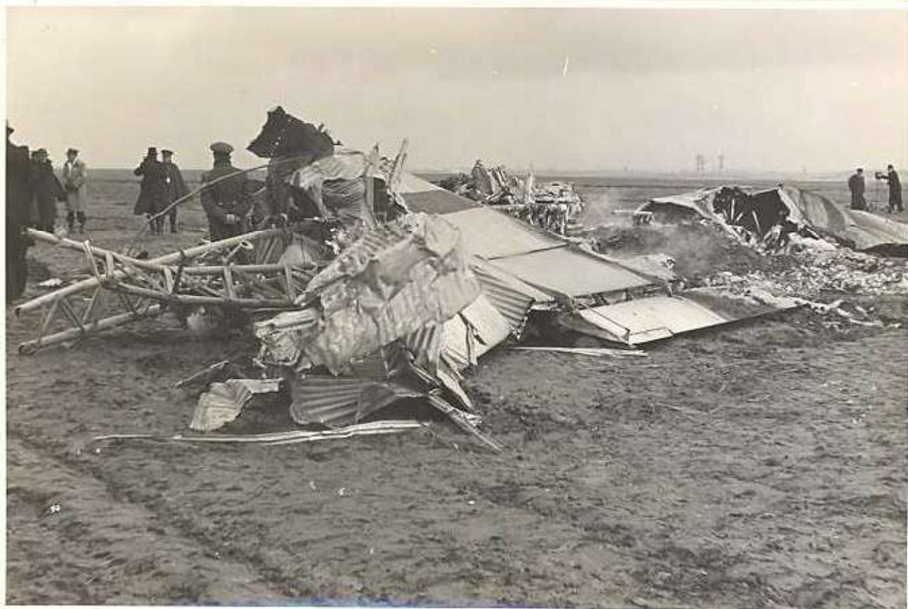
10.-Débris de l'extrémité, l'extra-dos de la partie centrale de l'écue gauche avec volet du dispositif hyperacoustique partiellement calcinés.
