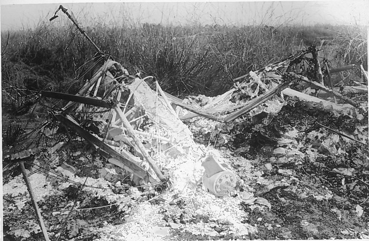
MOTEUR GAUCHE - LONGERON PLAN CENTRAL PLIE SUITE AFFAISEMENT TRAIN GAUCHE
