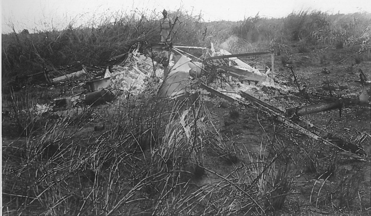
RAVINEMENT BORDURE SEUIL DE PISTE N° 32 AVEC TRACES D'IMPACT ROUE DROITE AU CENTRE.
