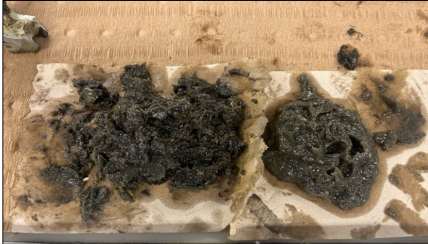
Fotografía No. 15: Grasa que genera rigidez en el núcleo de la hélice..
