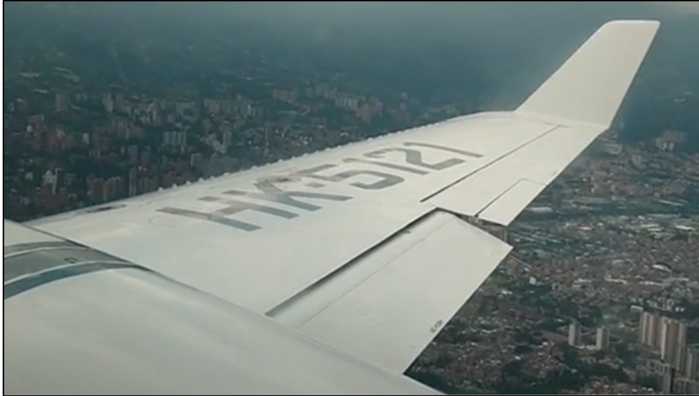
Fotografía No. 12: Vuelo reciente del HK5121; se observan los generadores de vórtice y los winglets.
