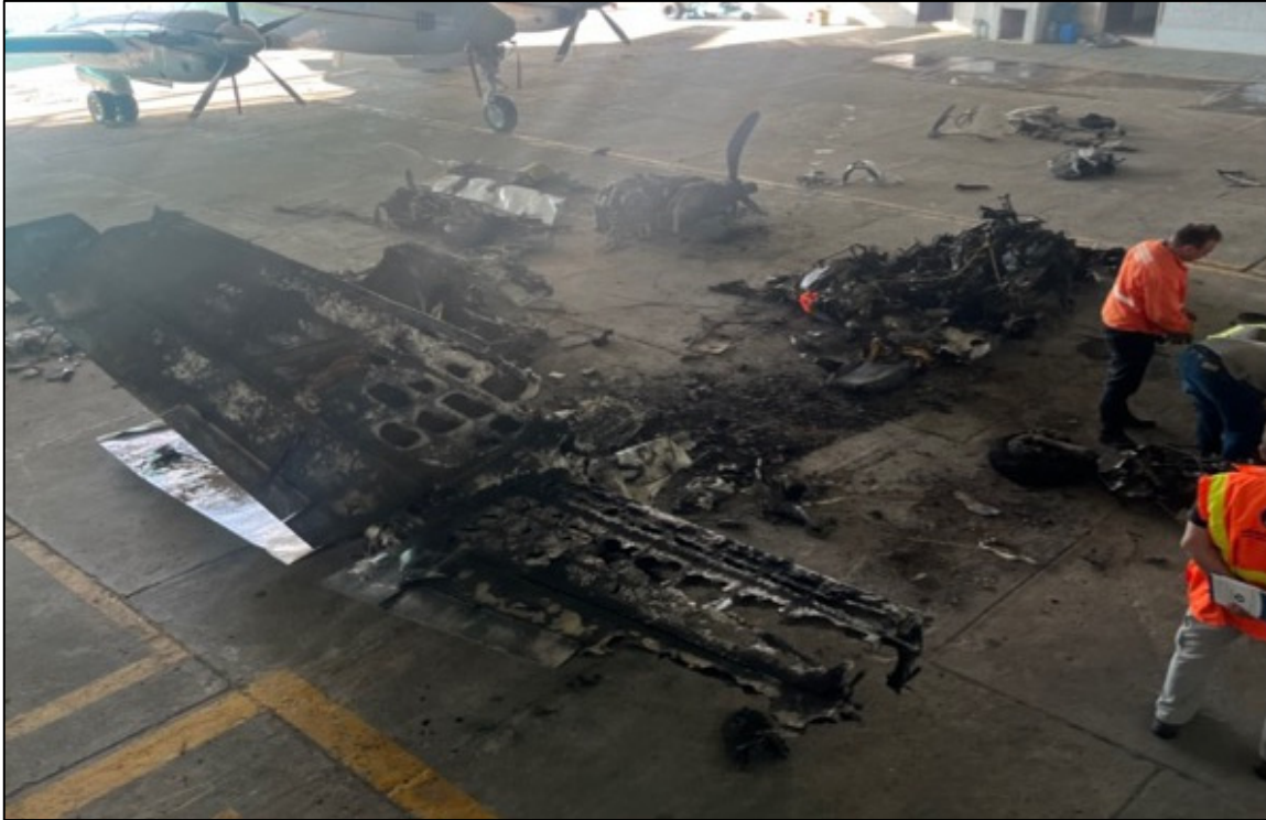
Fotografía No. 11: Reconstrucción de los restos de la aeronave.
