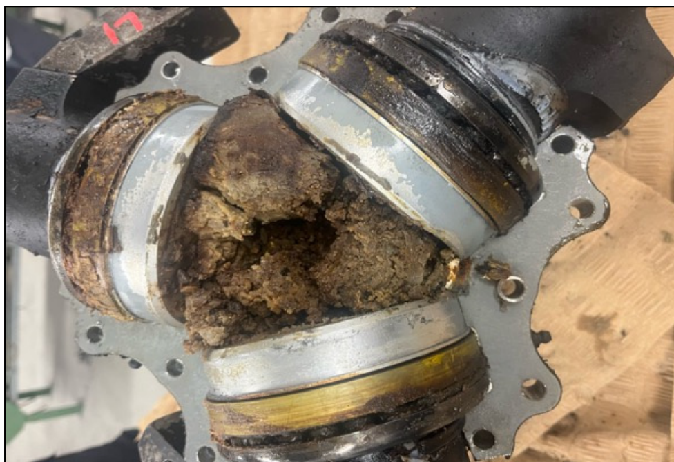
Fotografía No. 14: Núcleo de la Hélice donde se observa la cantidad de grasa.
