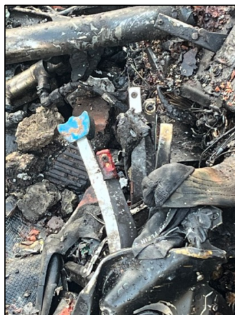
Fotografía No. 7: Palancas de control del motor (pedestal) en la cabina de mando.
