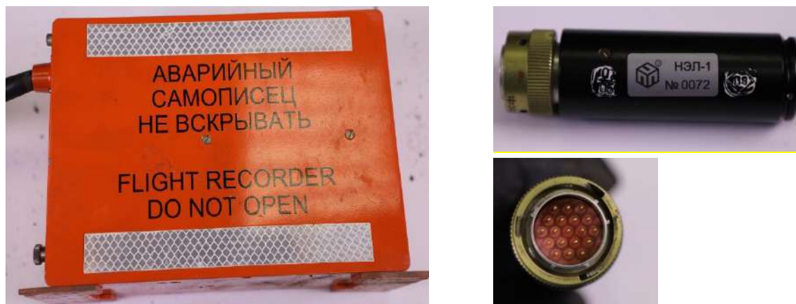
Рис. 6. Блок ЗБН системы БУР-СЛ с эксплуатационным накопителем параметрической информации
