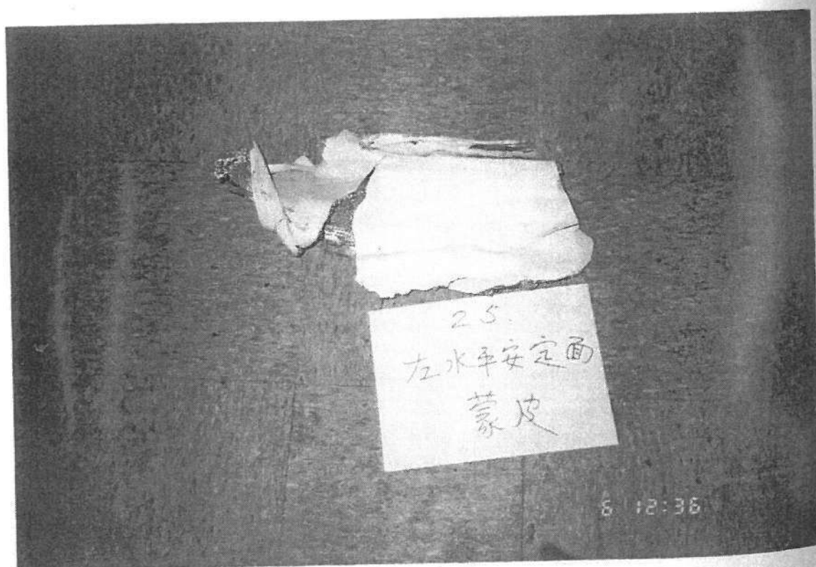
24. SKIN OF LH HORIZONTAL STABILIZER 左水平安定面蒙皮
