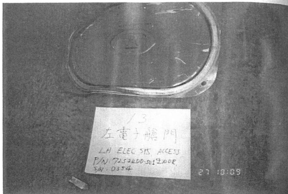
13 LH ELEC. SYS. ACCESS DOOR P/N: 7252400-501 S/N: 0354 左電子艙門
