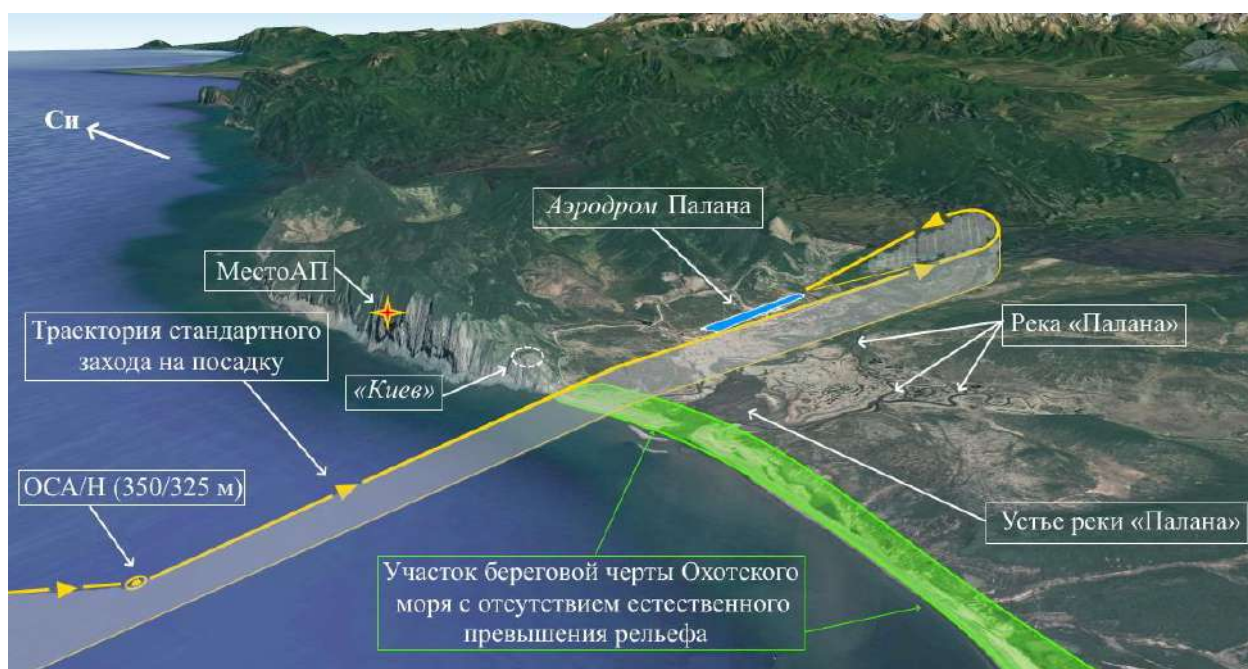
Рис. 32. Схема расположения места АП относительно схемы захода на посадку (выполнена не в масштабе), зеленым цветом выделен участок береговой черты с отсутствием естественного превышения рельефа
