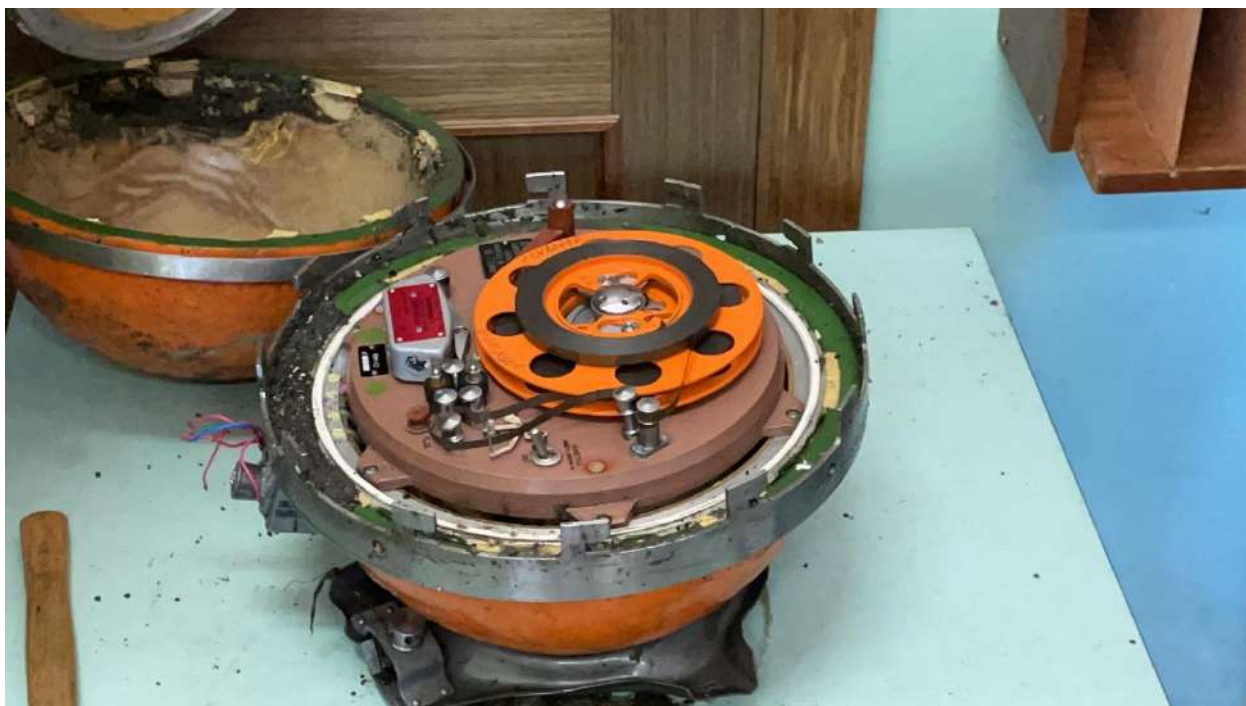
Рис. 12. Вскрытие контейнера с лентопротяжным механизмом
