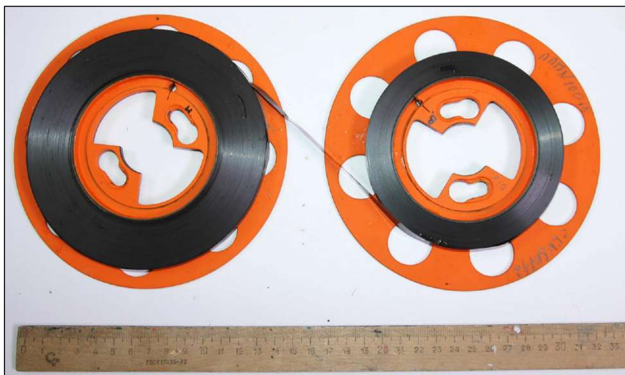
Рис. 13. Магнитная лента параметрического регистратора МСРП-12-96
