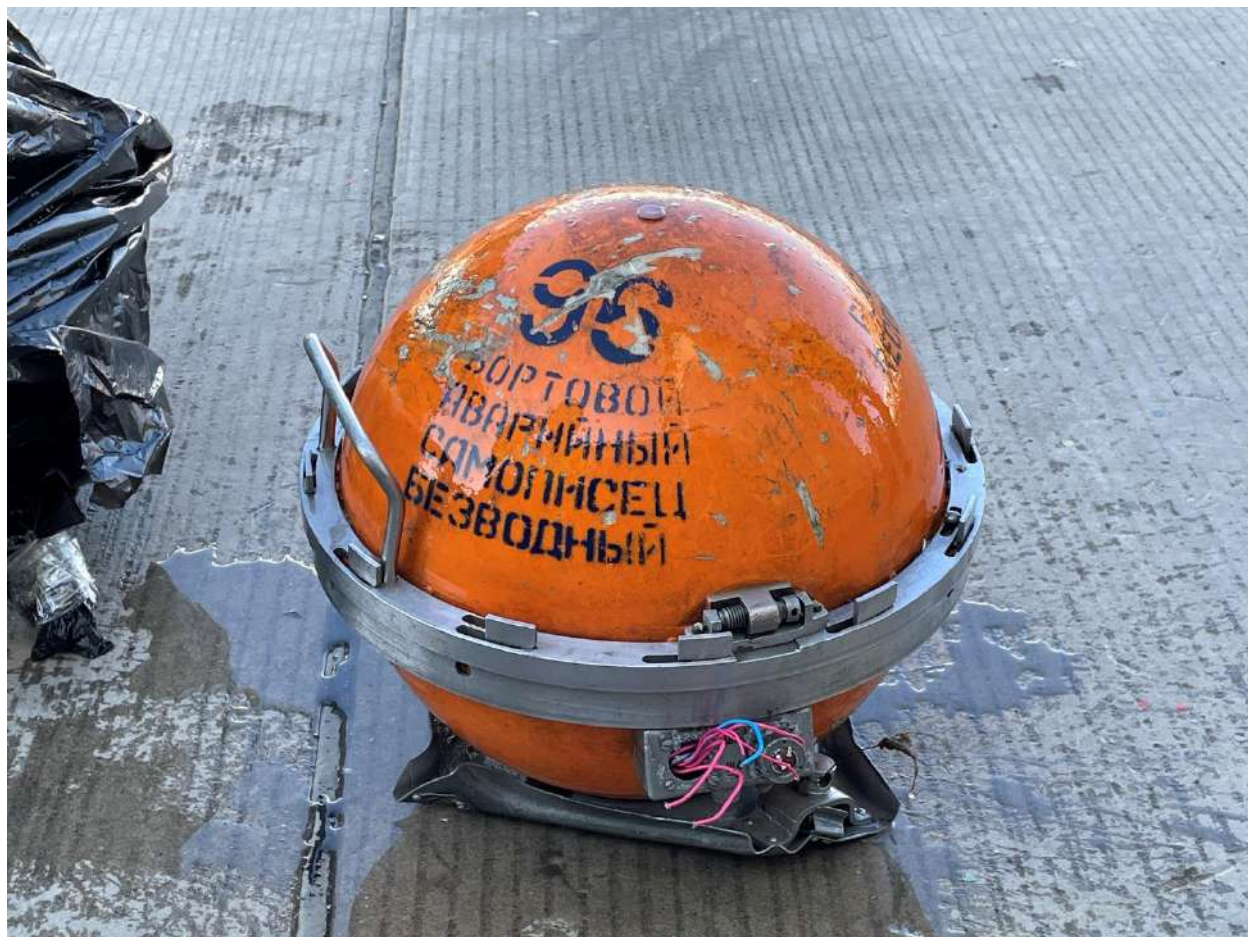
Рис. 11. Шаровой контейнер с лентопротяжным механизмом параметрического регистратора
