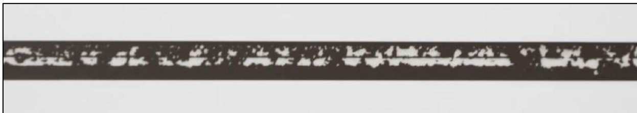
Рис. 14. Разрушение магнитного слоя ленты вблизи реверса
