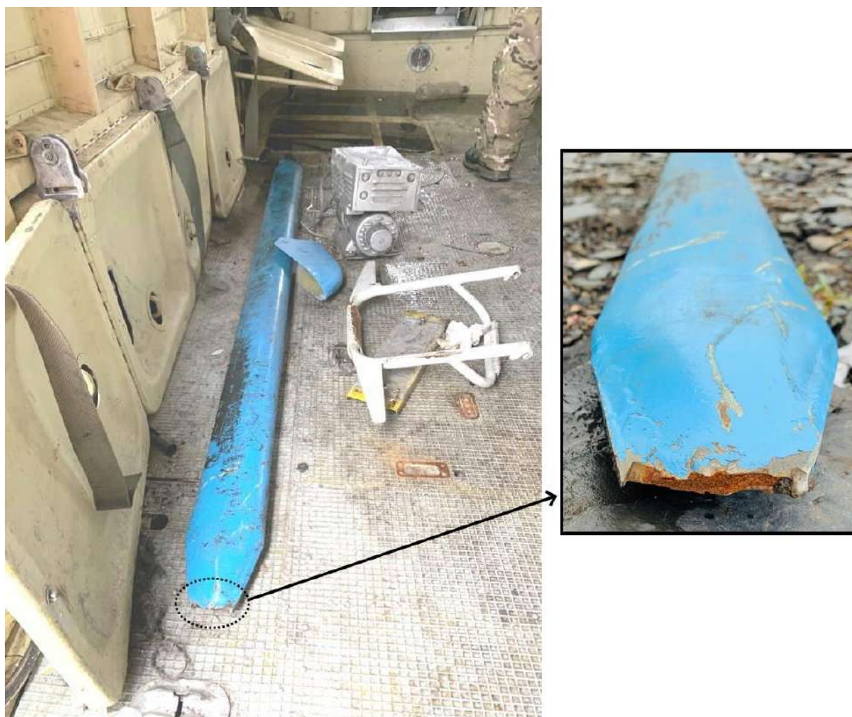
Рис. 3. Вид покоса шасси, обнаруженного в грузовой кабине, и вид места разрушения
