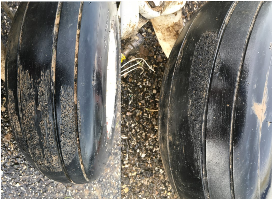
Figure 1 : trace de dévulcanisation sur les pneumatiques des trains principaux gauche et droit (Source : BEA)
