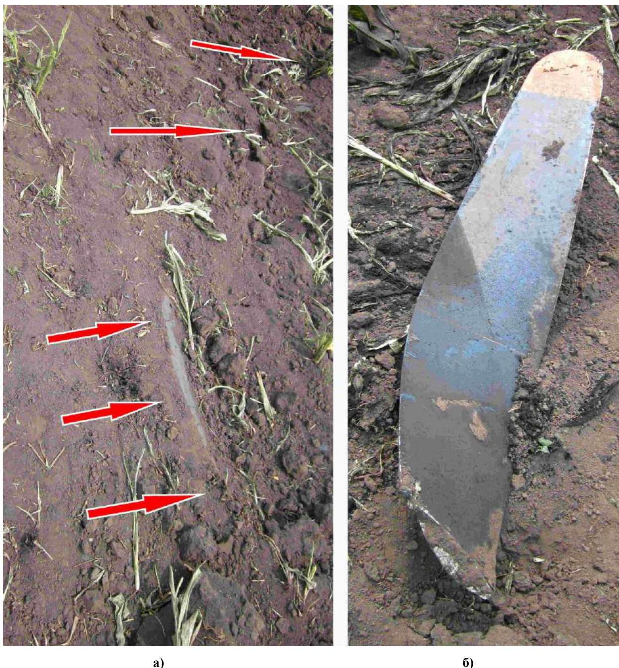
Рис. 7. Борозды, оставленные на месте АП от вращающихся лопастей ВВ (отмечено стрелками), и разрушенная лопасть
