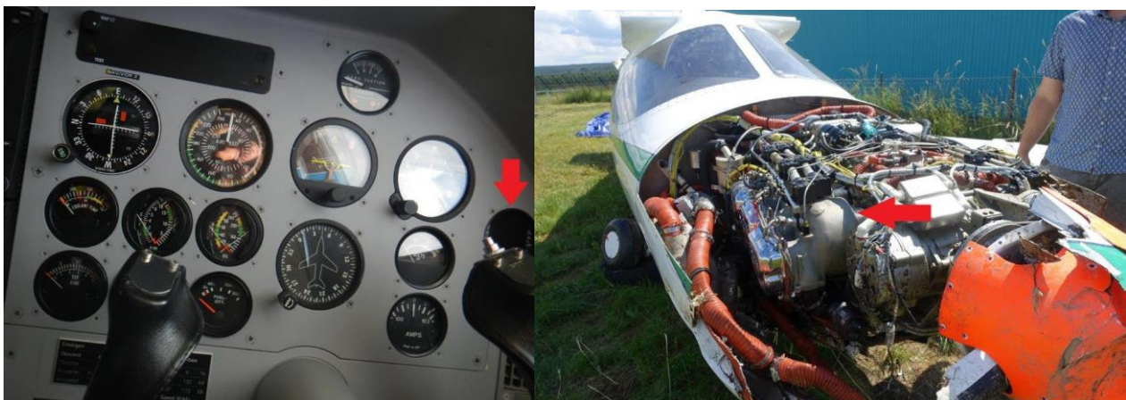
Obr. 7 - Nevhodné umístění indikátoru/zapisovače motorových dat EDM 800 mimo zorné pole pilota(levý obr.). Poloha válce číslo 5(obr.vpravo)
