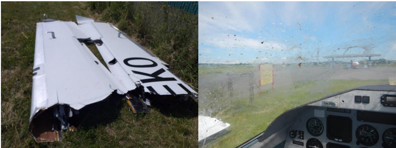
Obr. 6 - Části odlomené levé i pravé poloviny křídla a detail na potřísněné levé přední sklo
