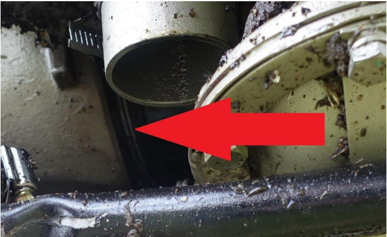
Obr. 8 - Z obrázku je patrné vysunutí hlavy ze závitu válce
