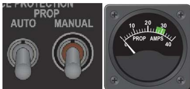
图 5: 螺旋桨除冰带位置及控制电门
