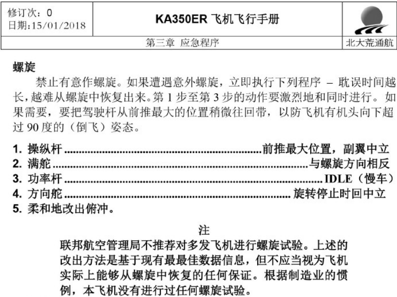
图 20：飞机螺旋改出程序
