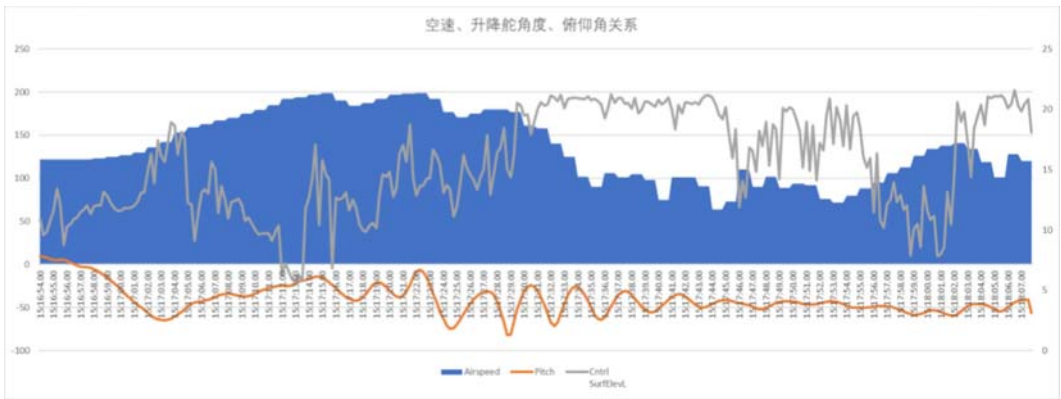
图 29：空速、升降舵和俯仰角关系图
