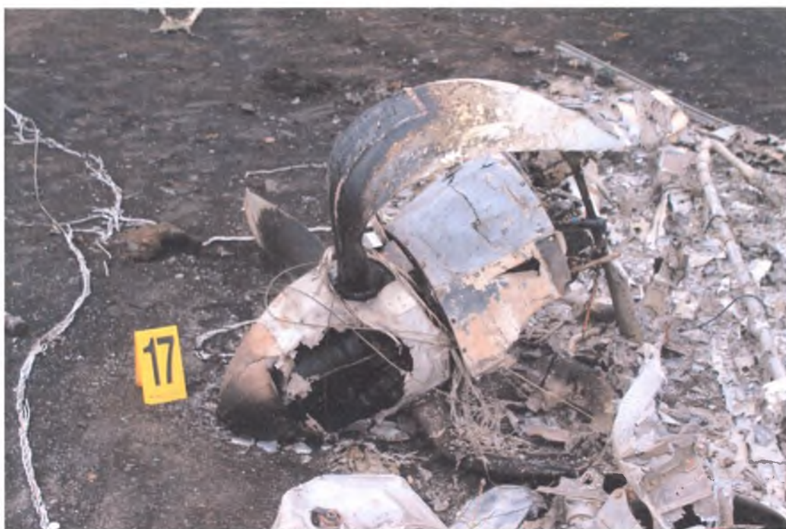
Рис. 6. Фрагменты разрушенного самолета №UP-A2807, воздушный винт с намотанными электропроводами линии электропередач.
