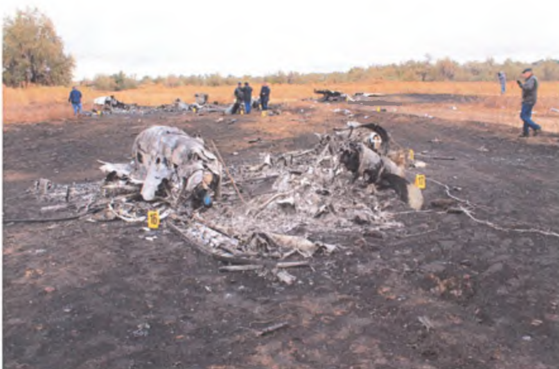
Рис. 4. Фрагменты разрушенного самолета №UP-A2807, левый двигатель.
