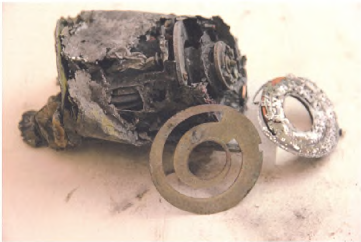
Рис. 21. Высотомер ВМ-15ПБ в момент поступления на исследование
