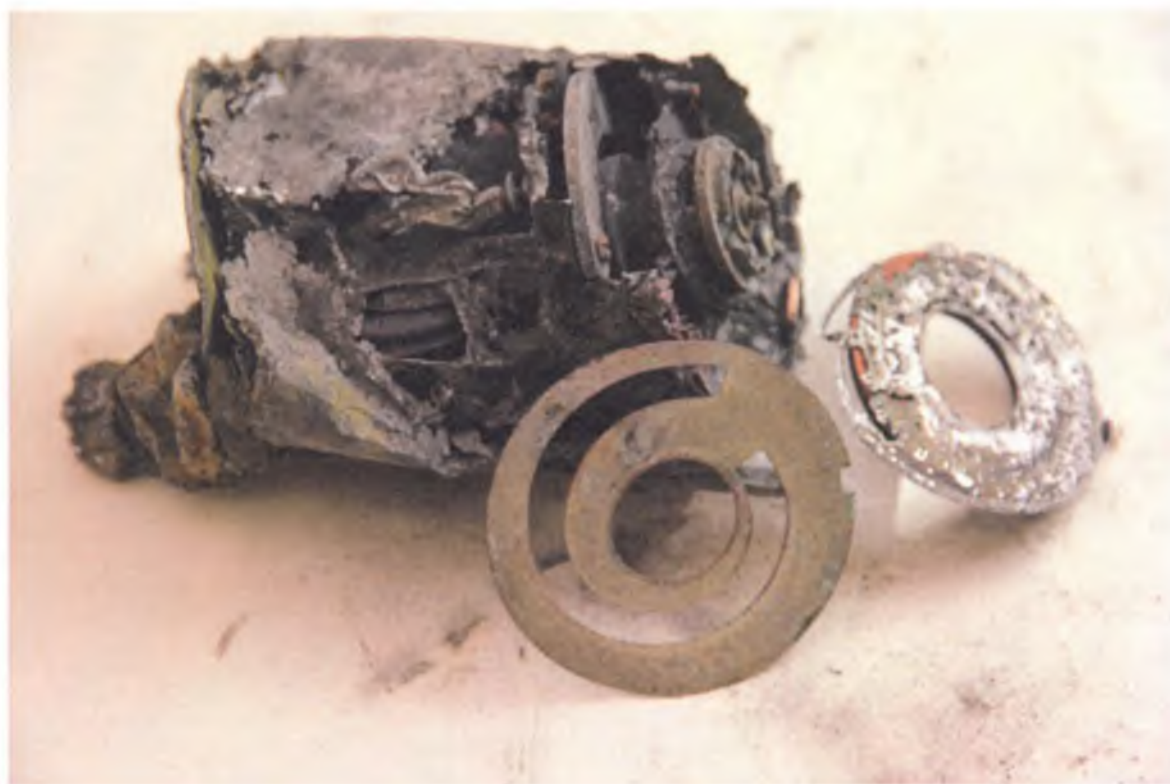
Рис. 21. Высотомер ВМ-15ПБ в момент поступления на исследование
