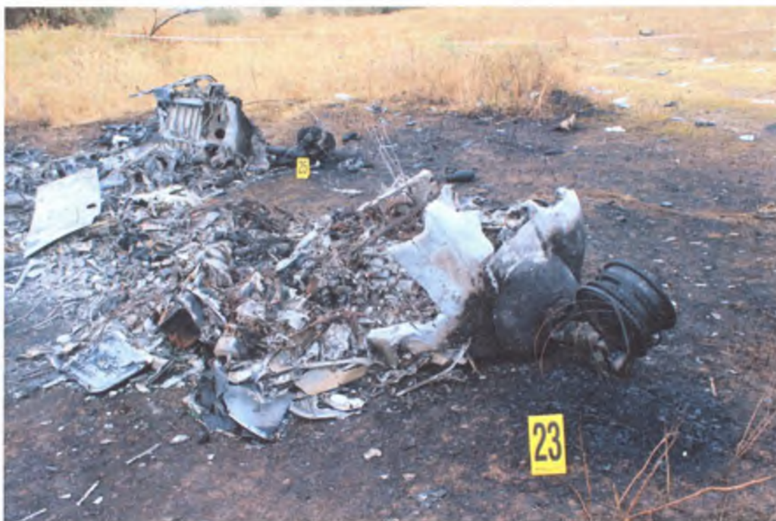
Рис. 3. Фрагменты разрушенного самолета №UP-A2807, фюзеляж и передняя стойка.
