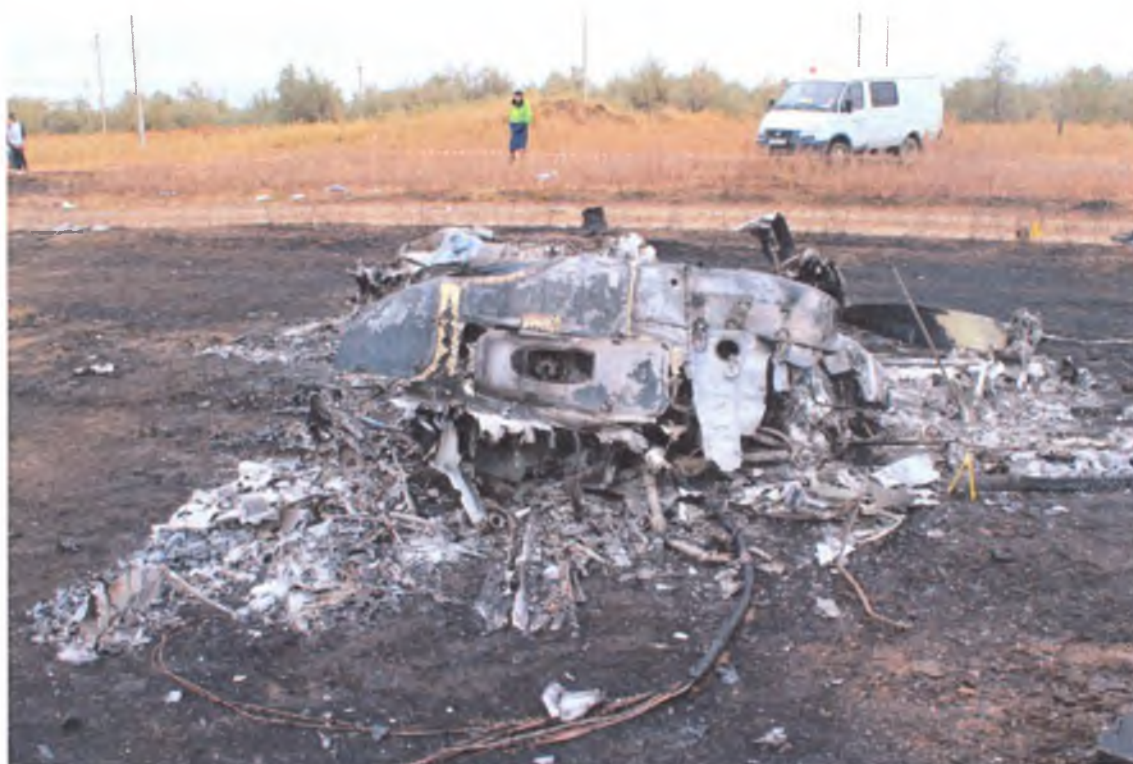
Рис. 2. Фрагменты разрушенного самолета №UP-A2807, правый двигатель.
