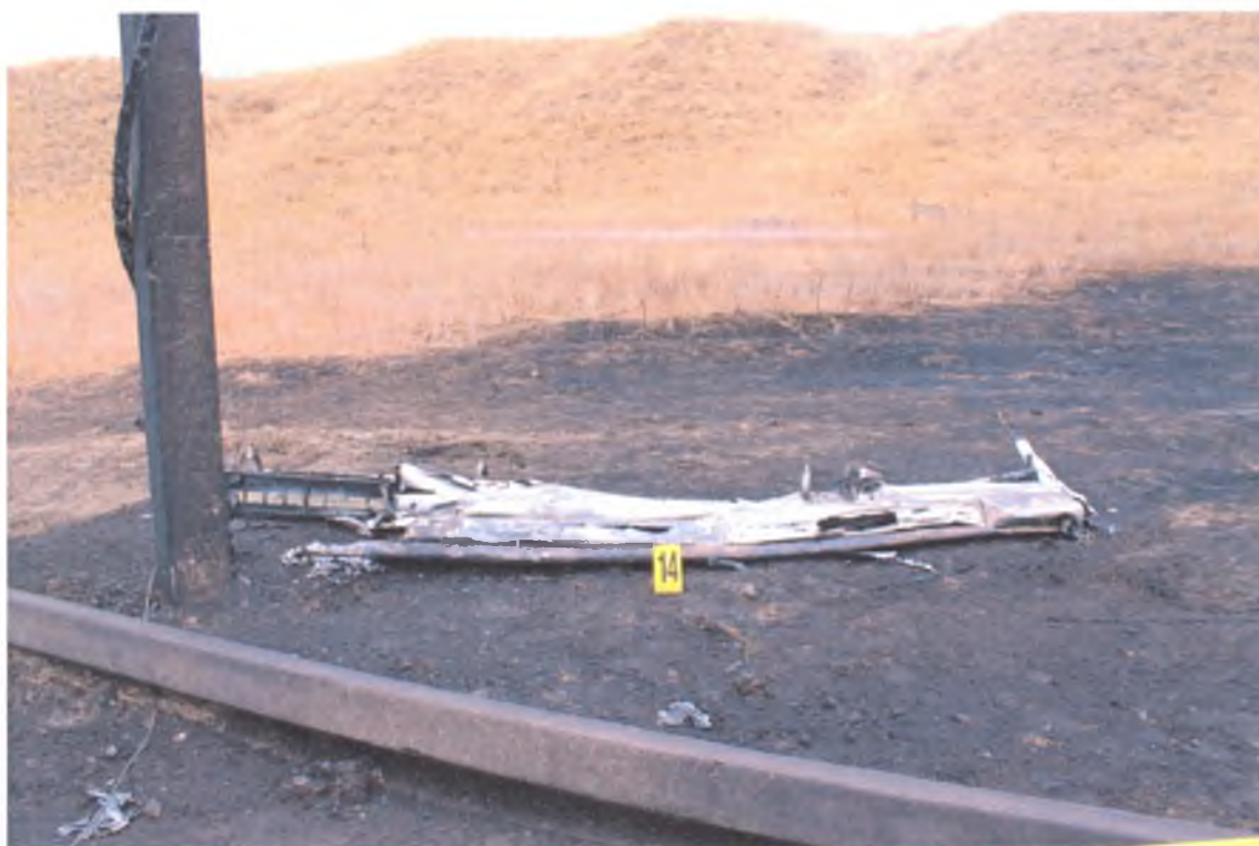
Рис. 15. Фрагменты правого полукрыла после столкновения со столбом и пожара
