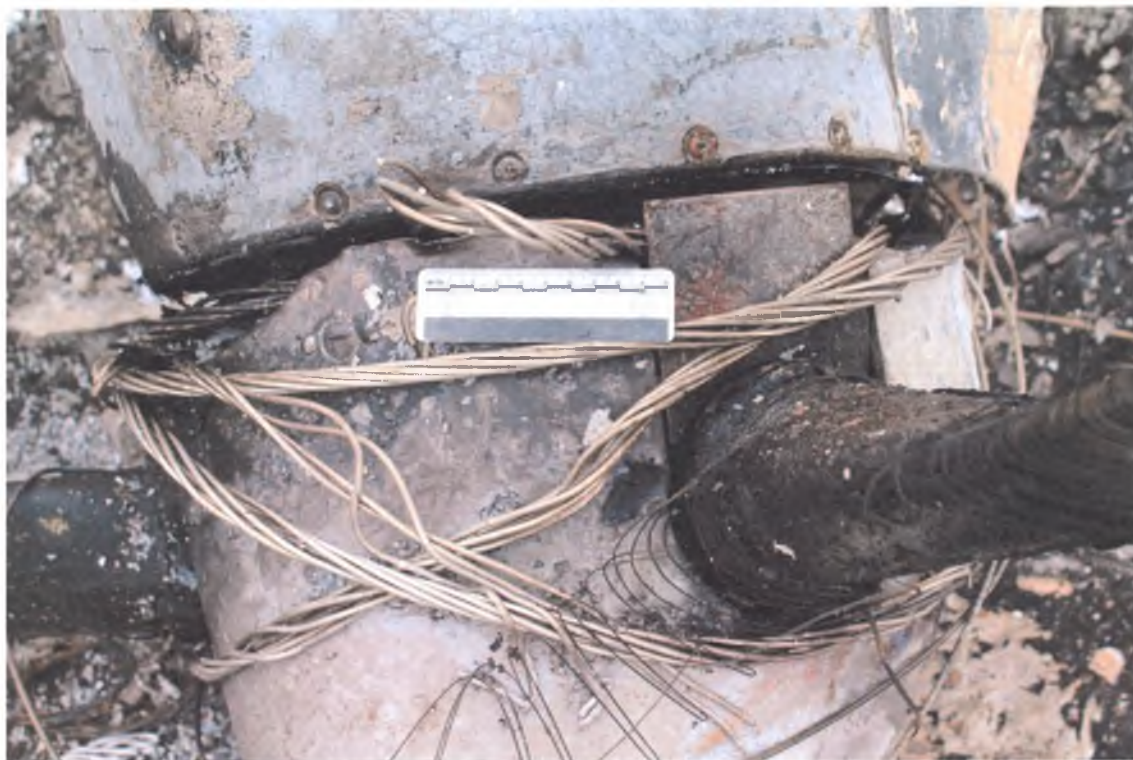
Рис. 7. Фрагменты разрушенного самолета №UP-A2807, воздушный винт с намотанными электропроводами линии электропередач (крупным планом)
