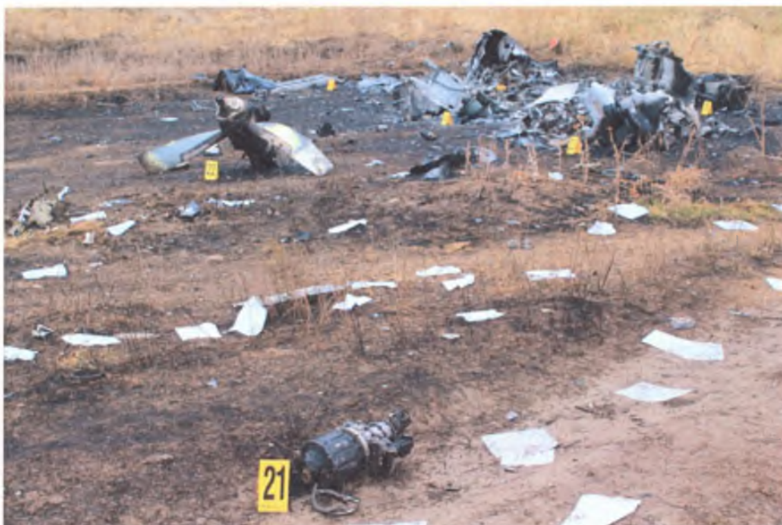
Рис. 5. Фрагменты разрушенного самолета №UP-A2807, воздушный винт.
