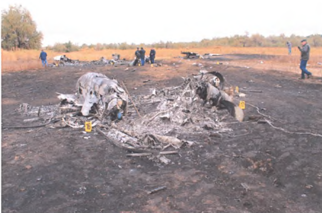
Рис. 4. Фрагменты разрушенного самолета №UP-A2807, левый двигатель.
