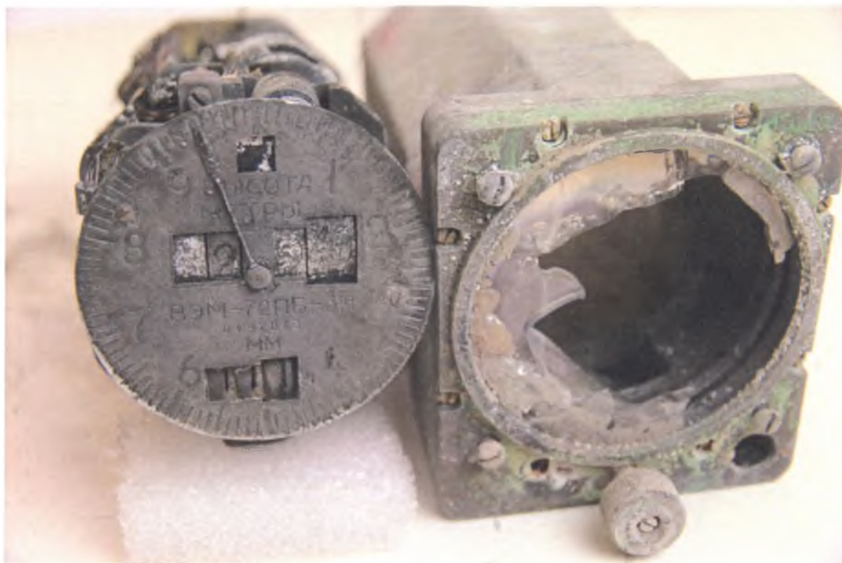
Рис. 20. Состояние электромеханического высотомера ВЭМ-72ПБ-3А в момент поступления на исследование.
