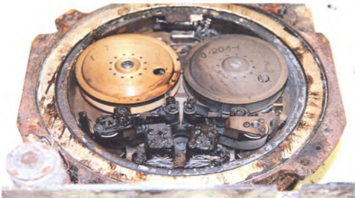
Рис. 10. Состояние МЛП-23-1 после снятия крышки
