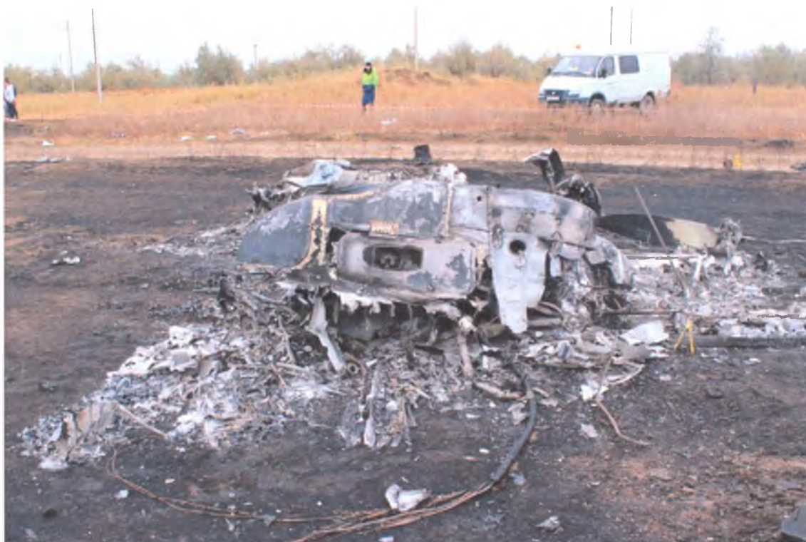
Рис. 2. Фрагменты разрушенного самолета №UP-A2807, правый двигатель.
