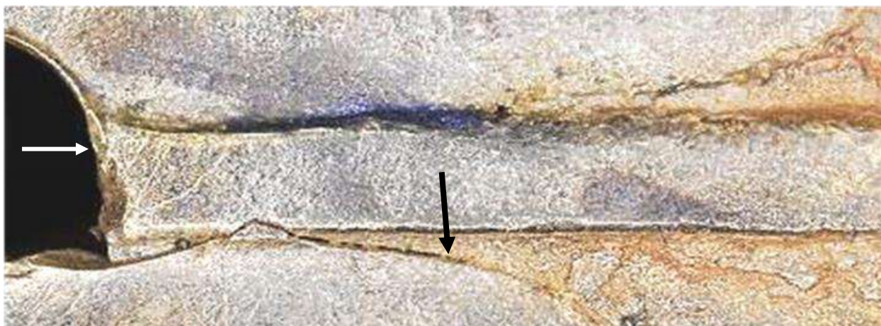
Рис. 11. Трещина в жаровой трубе № 2 и овализированное отверстие (показано стрелкой)
