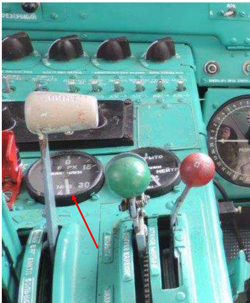
Рис. 9. Закрылки отклонены в положение 40°
