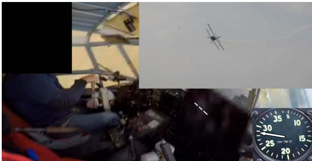
Рис. 7. Выход самолета за максимально допустимый угол крена
