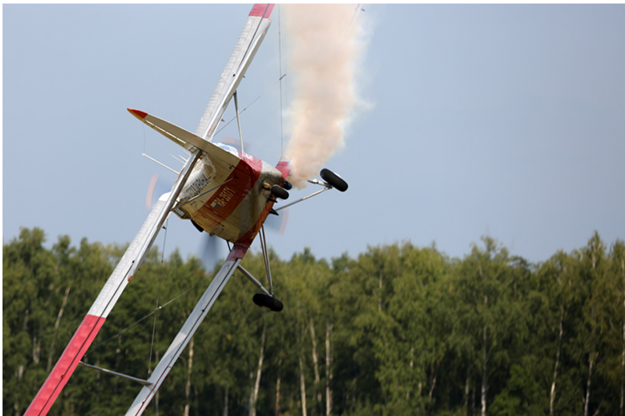
Рис. 13. Положение элеронов перед столкновением ВС с землей
