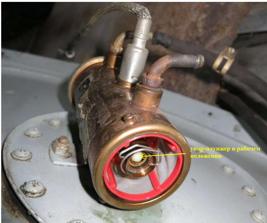
Рис. 17. Левый перекачивающий насос
