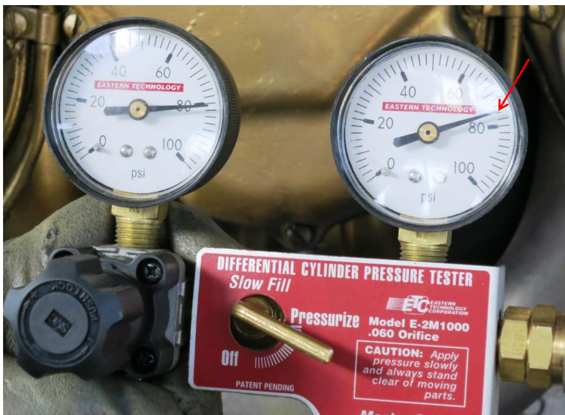
Рис. 23. Проверка цилиндра № 2 правого двигателя (красной стрелкой показано давление утечки)
