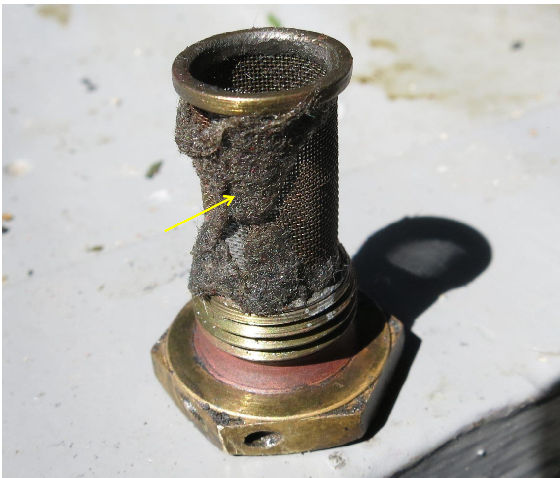
Рис. 19. Топливный фильтр тонкой очистки правого двигателя («загрязнения» показаны стрелкой)
