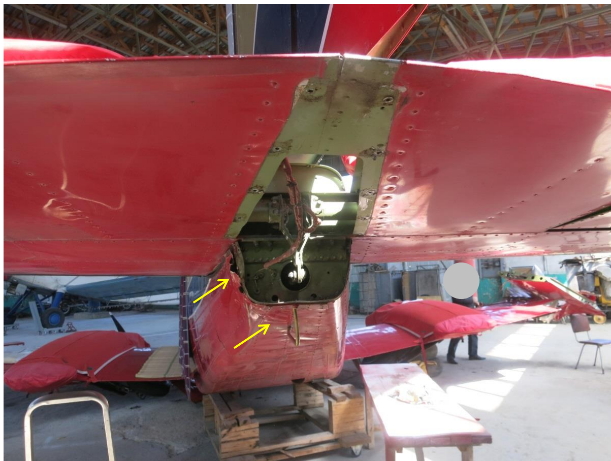
Рис. 11. Вид ВС сзади в месте ответственного хранения (стрелами показаны повреждения хвостовой части фюзеляжа)
