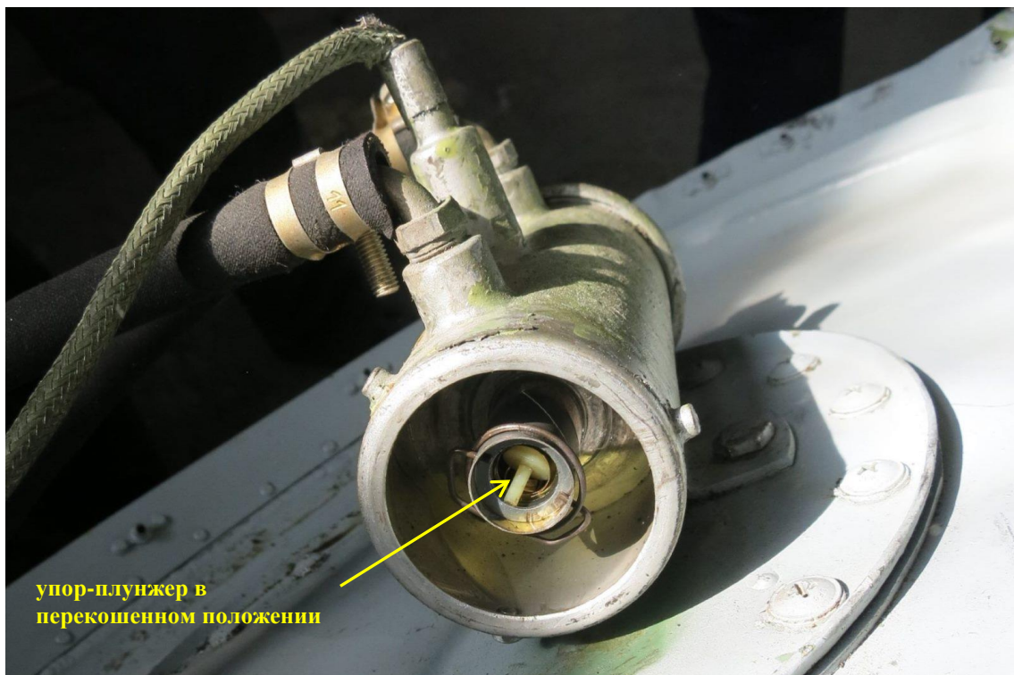
Рис. 16. Правый перекачивающий насос
