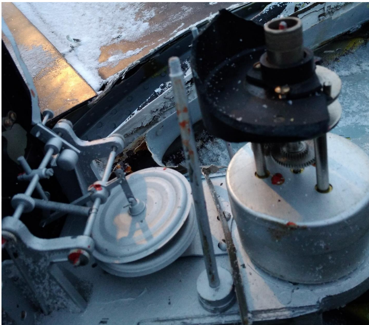
Рис. 6. Состояние барографа АД-2 после АП
