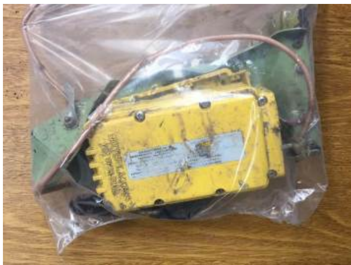
Figura 14. Equipo ELT preservado y analizado en taller externo
