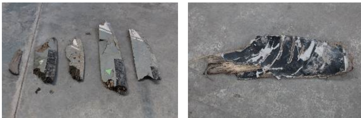
Figura 8. Fragmentos de pala y de las marcas que evidencian el giro de la hélice al momento del impacto
