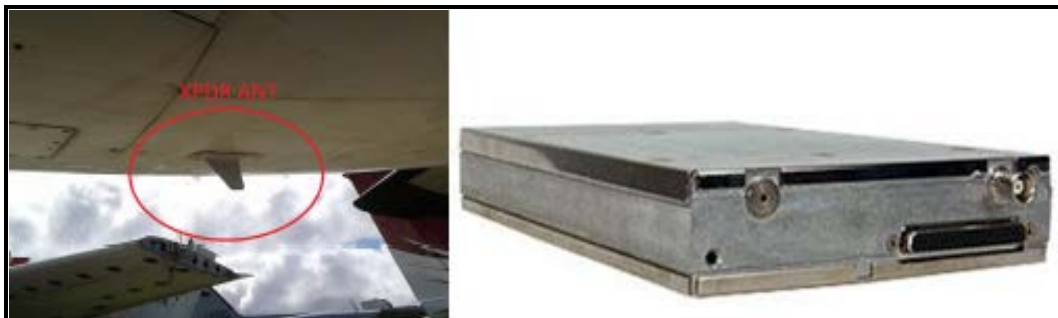
Figura 37. Garmin GTX 32 con su antena correspondiente
