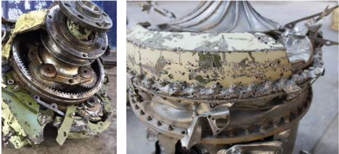
Figura 6. Estado interno del PGB derecho, luego de su limpieza
