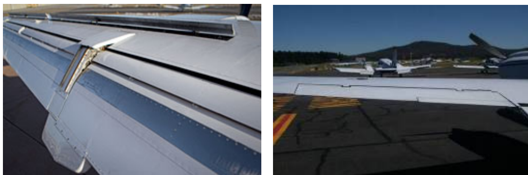
Figura 31. Spoilers (izquierda) y alerones (derecha) utilizados para el control lateral
