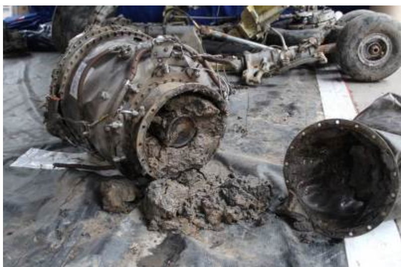
Figura 3. Detalle de la mezcla de lodo y combustible en el interior del motor
