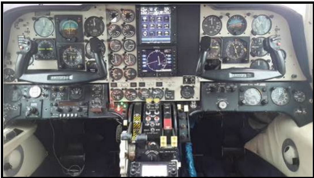
Figura 5. Comandos e instrumentos en cabina del LV-MCV
