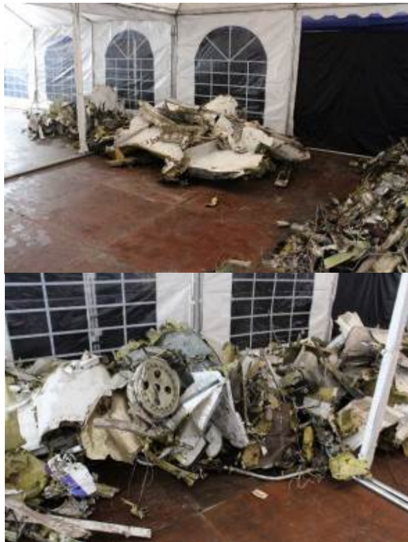
Figura 9. Estado inicial de los componentes de control y superficies principales, luego de la primera limpieza, previamente a su catalogación
