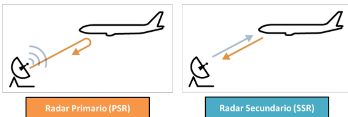
Figura 36. Funcionamiento de los radares tipo PSR y SSR
