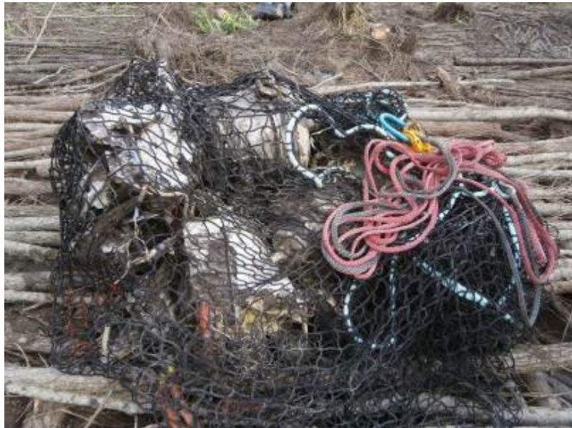
Figura 35. Componentes de la aeronave en la red previamente a ser izada por el helicóptero
