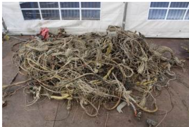
Figura 13. Restos generales del encablado de la aeronave
