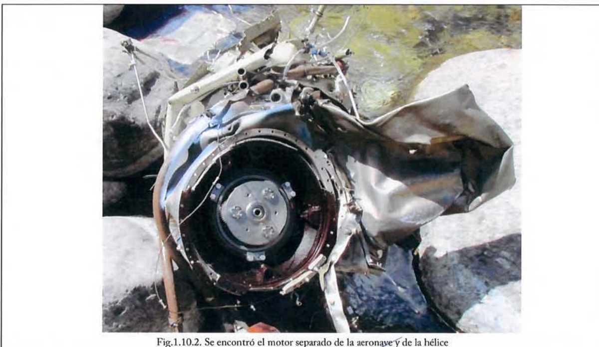
Fig.1.10.2. Se encontró el motor separado de la aeronave y de la hélice
