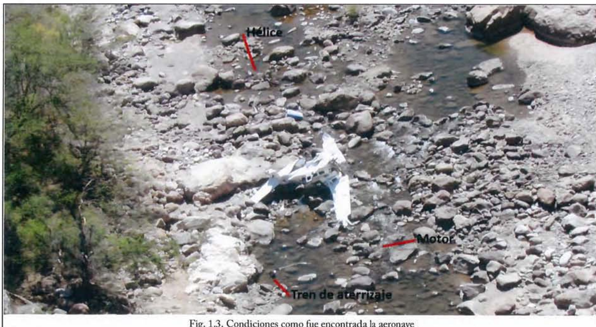
Fig. 1.3. Condiciones como fue encontrada la aeronave
