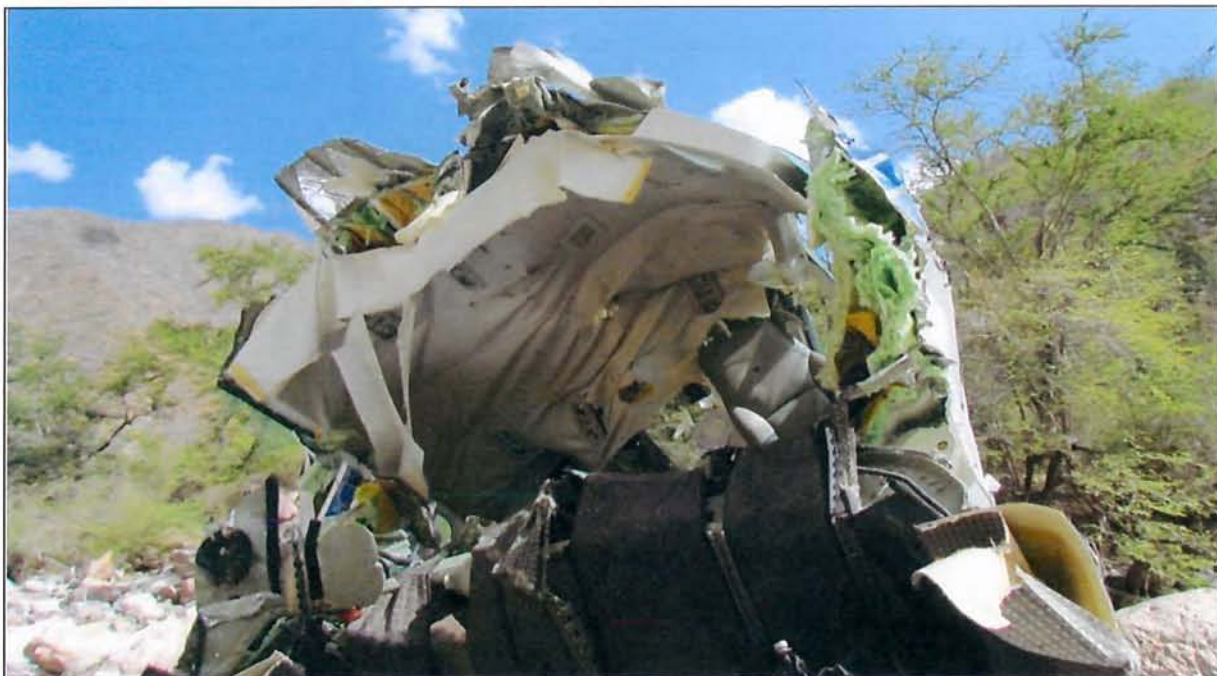
Fig. 1.9.1. Daños estructurales presentes en la aeronave partida por la mitad
