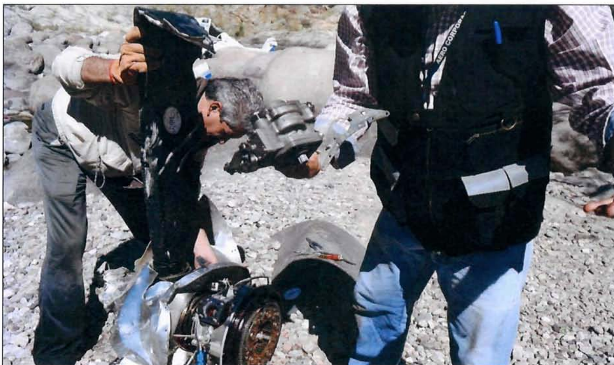
Fig.1.10.1. Extracción del gobernador de la hélice
