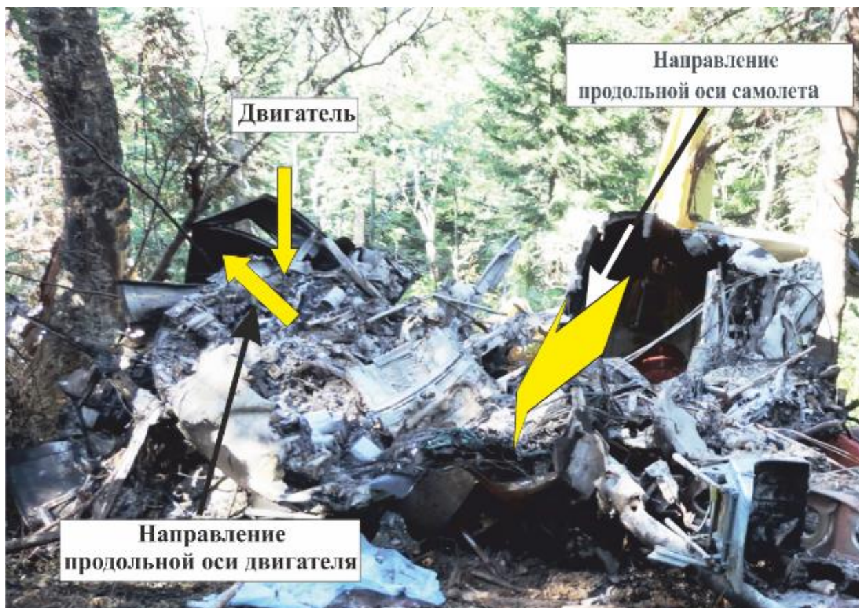
Рис. 8. Положение двигателя относительно продольной оси ВС
