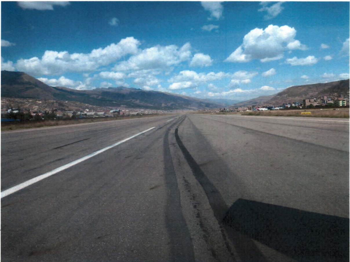
Oscilaciones laterales del principal izquierdo luego que el ob-2040-P hiciera contacto con la pista
