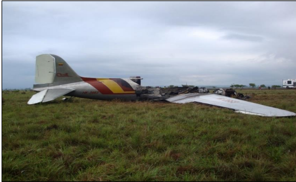
Fotografía No. 3: Partes no consumidas por el fuego
