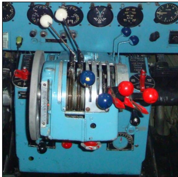
Fotografía No. 9: Condición normal de pedestal de Hélices, Potencia, Mezcla
