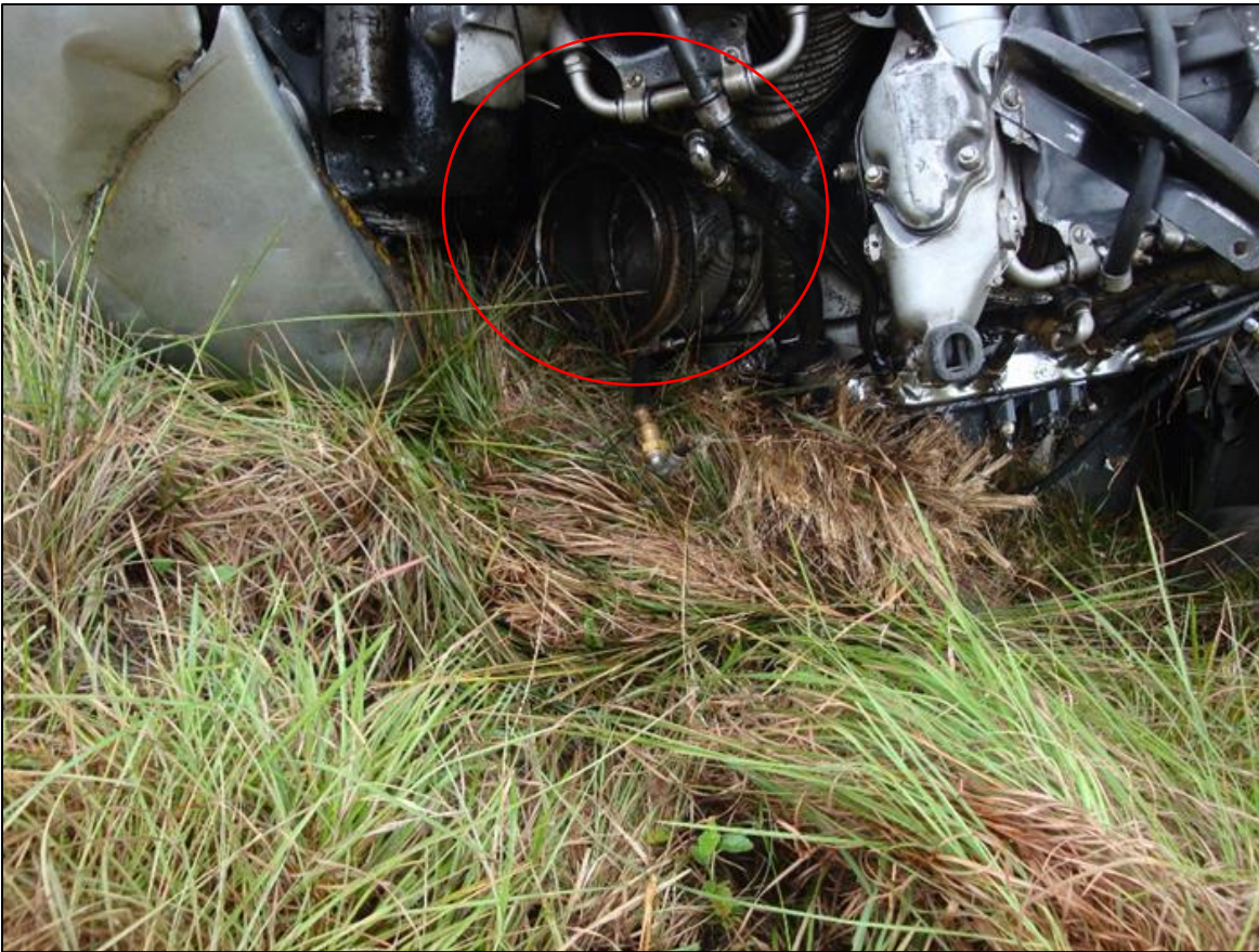
Fotografía No. 6: Evidencia motor izquierdo rompimiento cilindro
