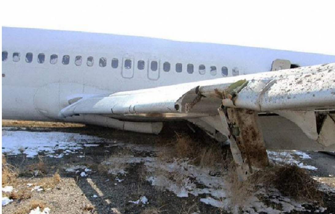
شکل : خسارت وارده به بال سمت چپ هواپیما
