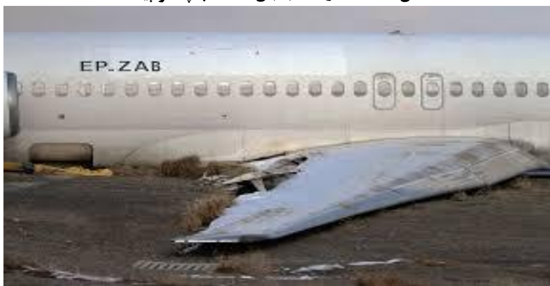
شکل : خسارت وارده به بال سمت چپ هواپیما
