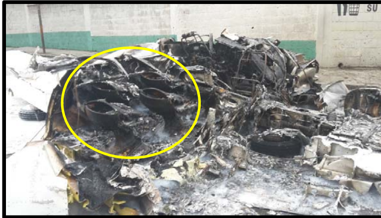
Fotografía No.: 09 Vista de la cabina de pasajeros y los asientos de la aeronave incinerados.
