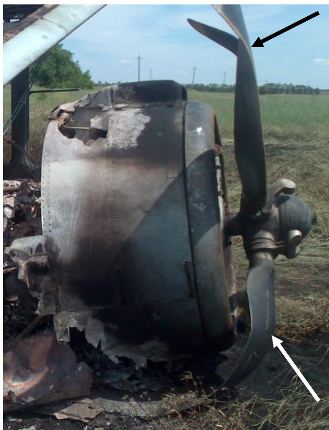
Рис. 7. Степень загнутоги лопастей АВ-2
