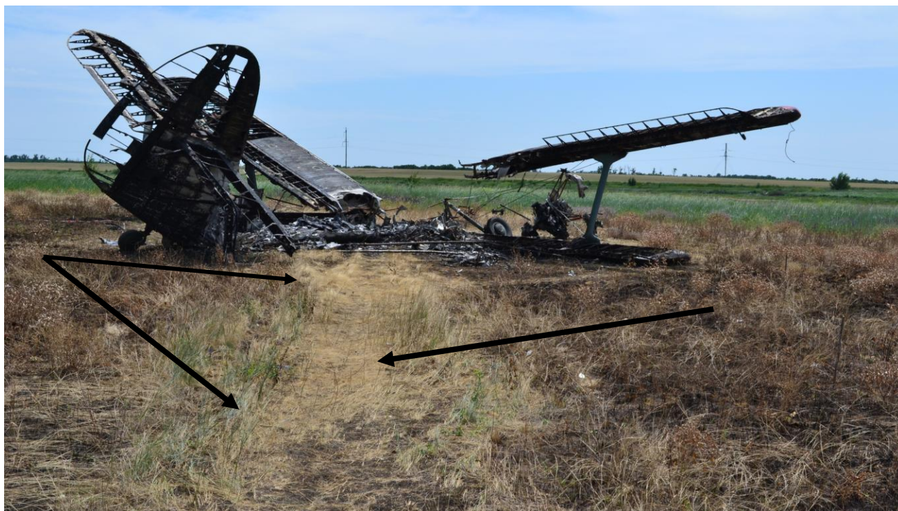
Рис. 2. Следы от движения самолёта на фюзеляже и от лопасти воздушного винта
