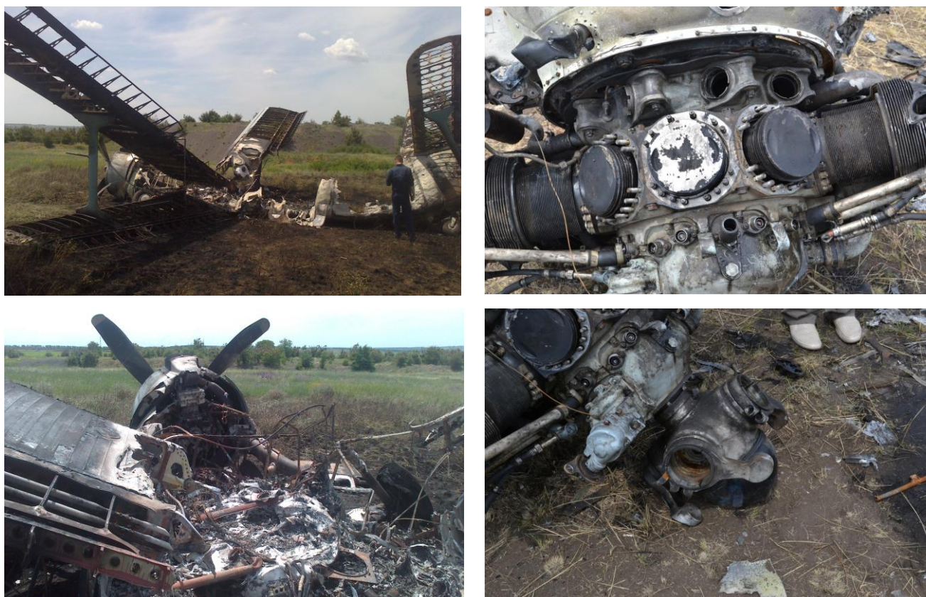
Рис. 1. Состояние воздушного судна после пожара на земле (фото слева). Утрата лопастей воздушного винта и фрагментов двигателя, обнаруженная комиссией на месте АП (фото справа)
