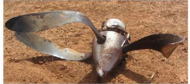
Fig. 1.12.6. Las palas de la hélice del motor posición número dos también muestran pocas revoluciones de giro
