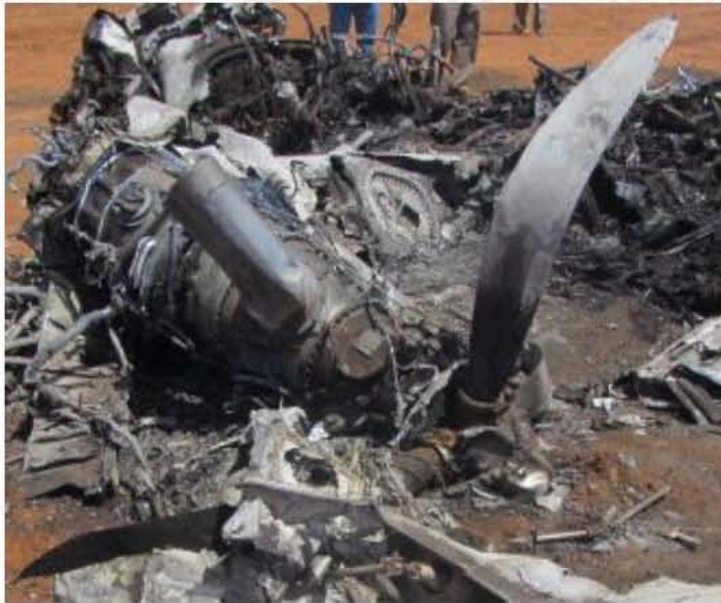
Fig. 1.12.2. Palas de la hélice del motor posición número uno con evidencias de estar con poca potencia
