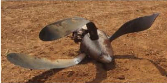
Fig. 1.12.5. Palas de la hélice del motor posición número dos se desprendió del motor
