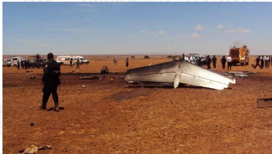
Fig. 1.3. 2 El tipo de combustible (turbosina) es muy flamable lo que ocasiona que una vez incendiado no se apaga con facilidad consumiéndose en su totalidad el fuselaje de la aeronave
