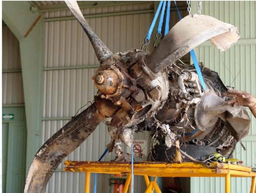
Fig. 1.12.4. Motor 1 se encontró operativo y con señales de haber absorbido tierra de la zona en la que cayó la aeronave
