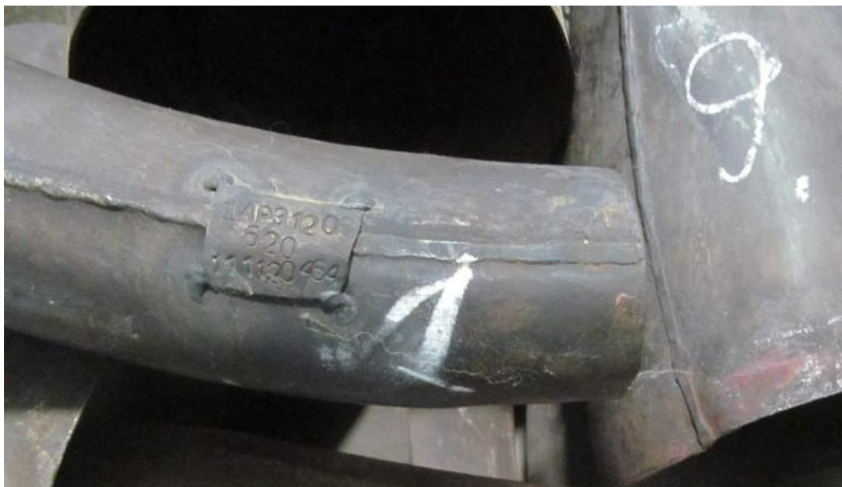
Рис.8 Состояние бирки выхлопного коллектора самолета Ан-2 RA-40382
