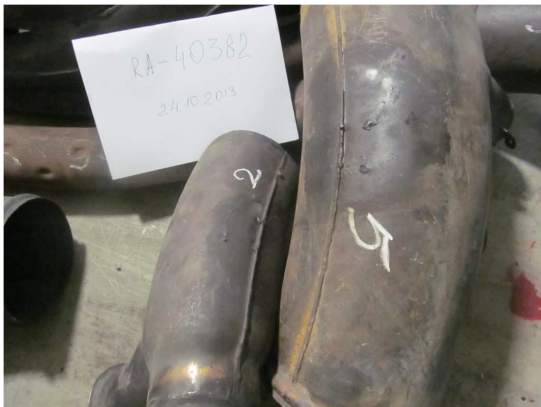
Рис.9 Отсутствие бирок и следы от мест их приварки на секциях выхлопного коллектора самолета Ан-2 RA-40382
