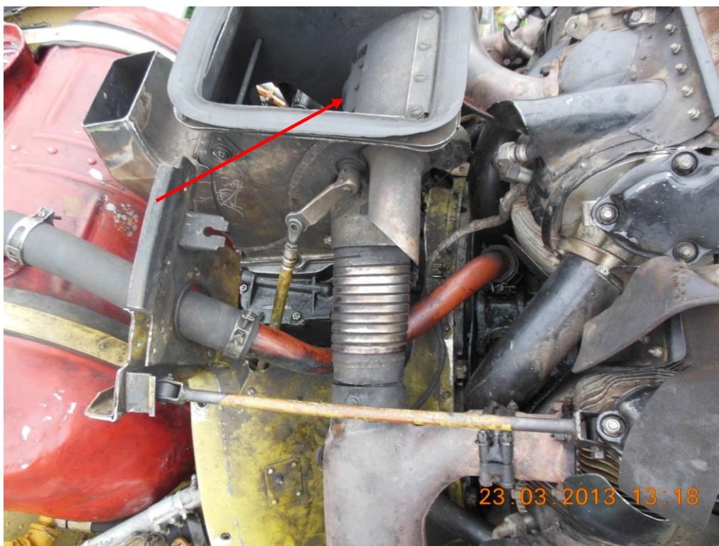
Рис. 15 Состояние заслонки всасывающего устройства карбюратора
