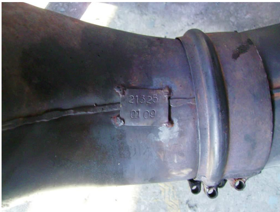
Рис.7 Состояние бирки выхлопного коллектора самолета Ан-2 RA-40616
