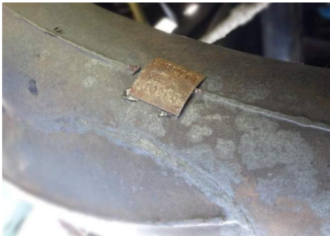
Рис.10 Состояние бирки выхлопного коллектора самолета Ан-2 RA-33622
