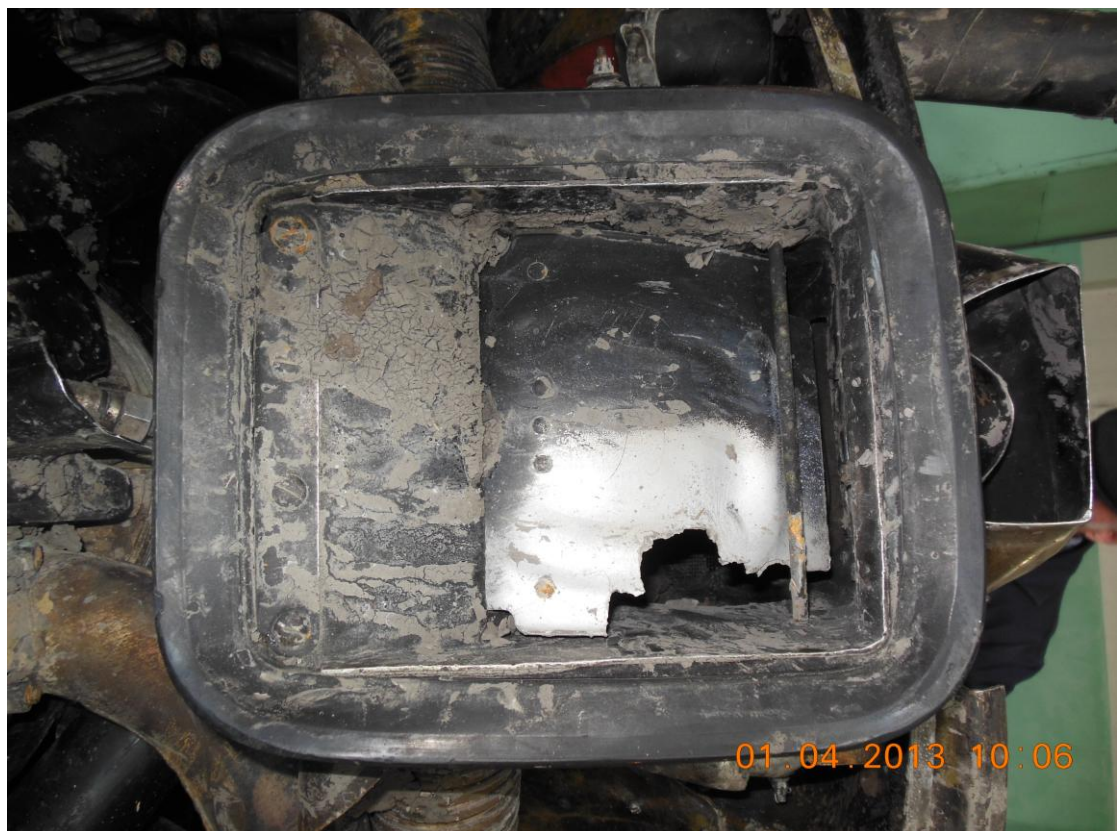
Рис. 5 Состояние заслонки всасывающего устройства карбюратора после авиационного происшествия
