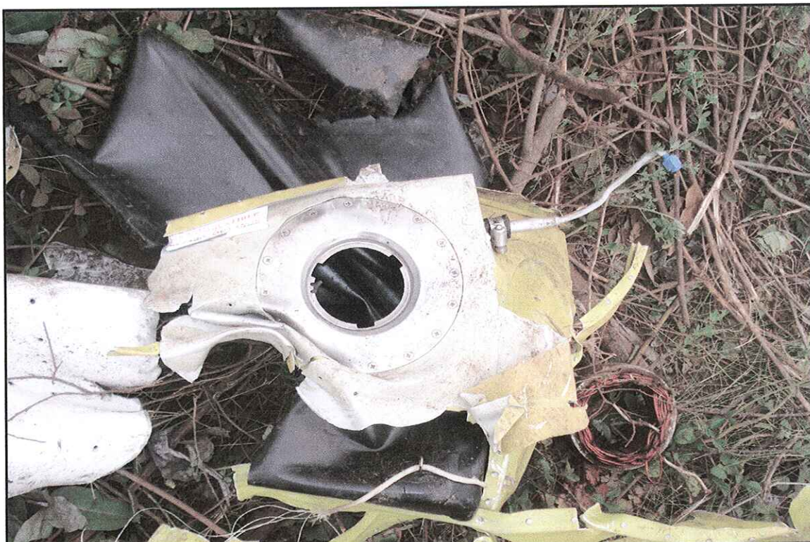
Fotografía 5: Parte de uno de los estanques de combustible encontrado en el lugar del primer impacto.
