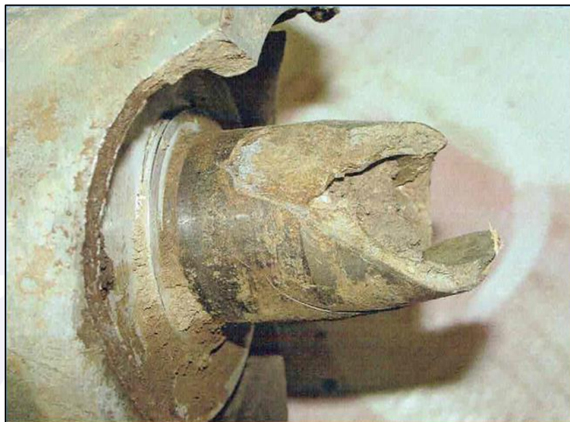
Figura 3 -Vista da fratura da espiga da hélice, mostrando sobrecarga e rompimento por torção.
