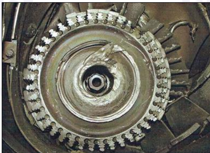
Figura 2 - Vista da turbina de potência do motor, onde se nota que algumas palhetas se romperam na raiz, indicando rotação elevado no momento do impacto.
