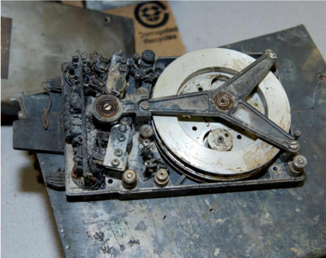
Fotografía de la caja que contiene los circuitos, mecanismo de grabación y cinta magnética de la unidad de DFDR con signos de haber estado sometido a muy altas temperaturas.
