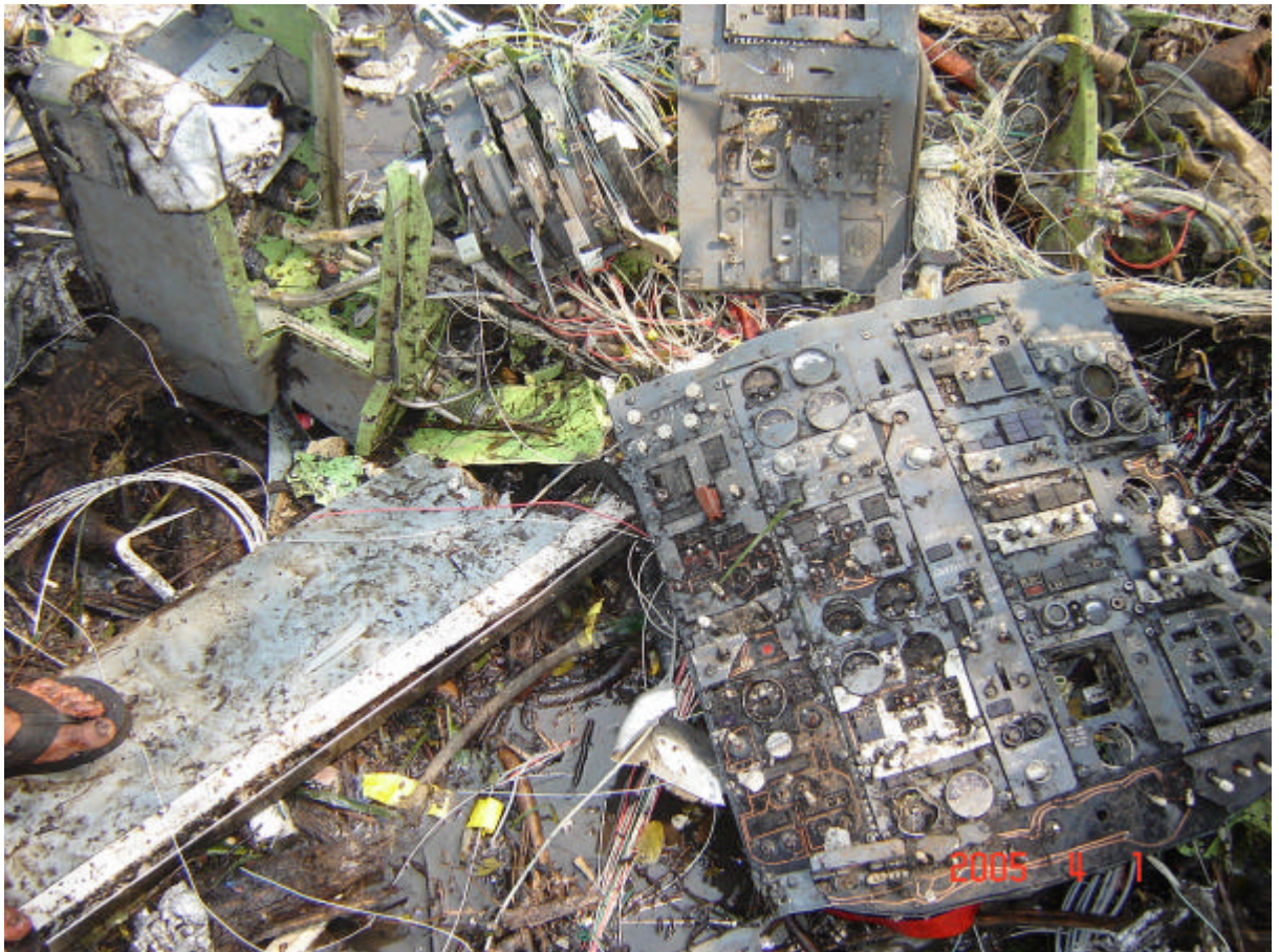
Fotografía de los restos del panel de instrumentos superior y del cuadrante localizados dentro de la cabina de mando de la aeronave.
