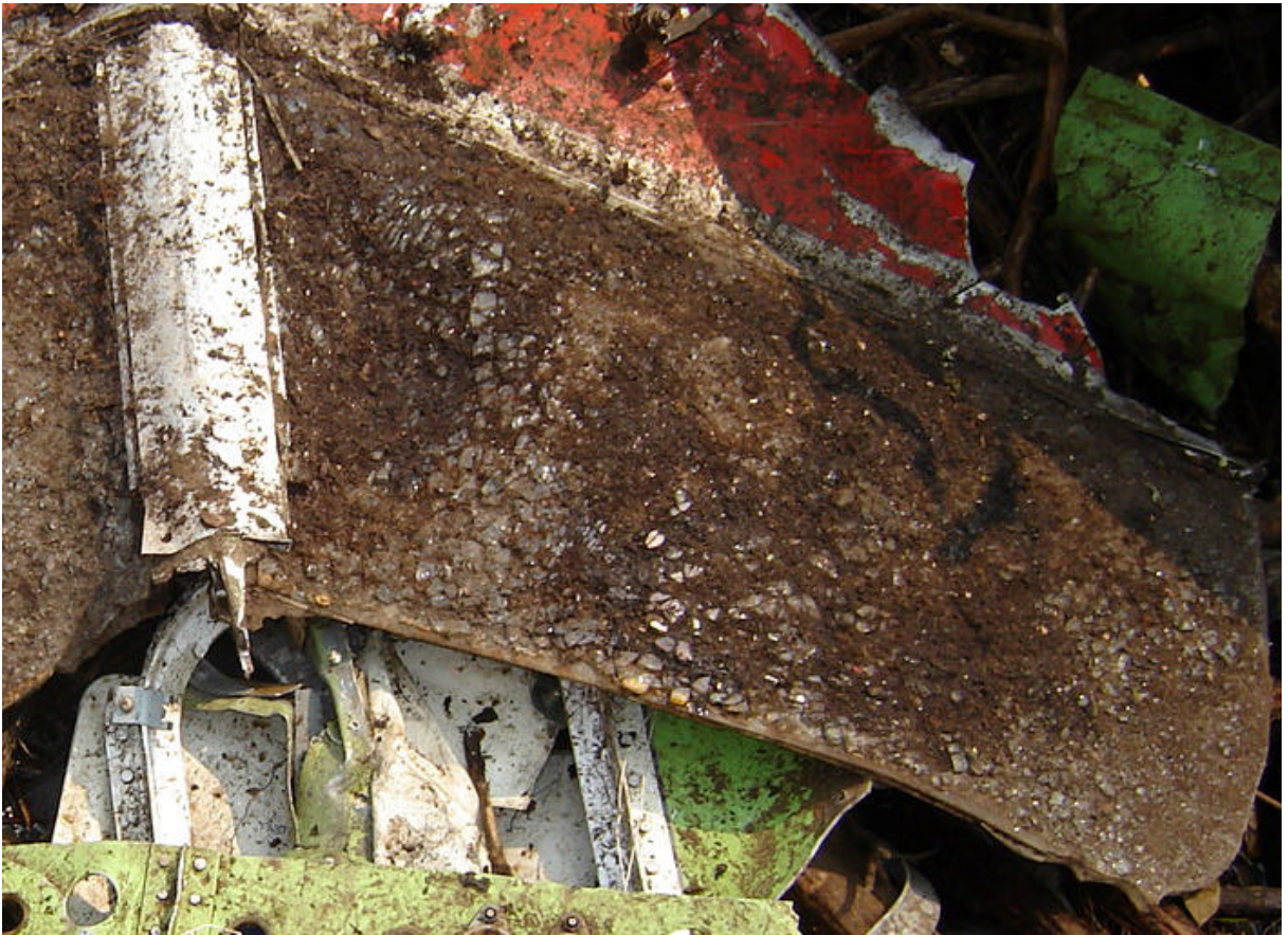
Detalle de parte del parabrisas delantero de la cabina de mando, con daños similares al causado por el impacto de granizo.
