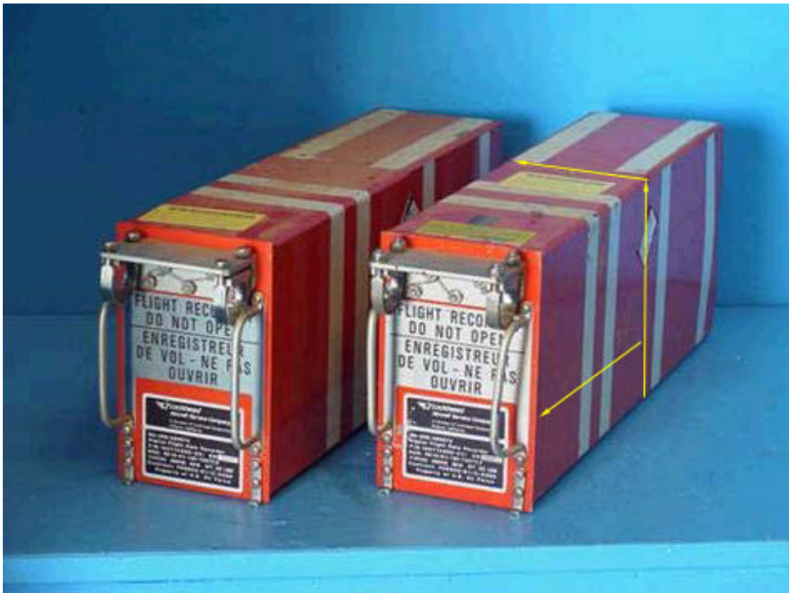
Foto comparativa de una unidad de DFDR Lockheed, las líneas amarillas nos indican la parte que fue devuelta por el poblador.
