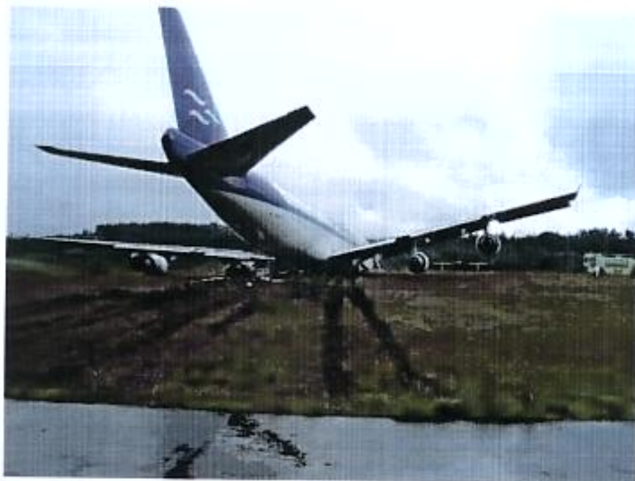
HUELLAS EN LA ZONA DE SEGURIDAD
