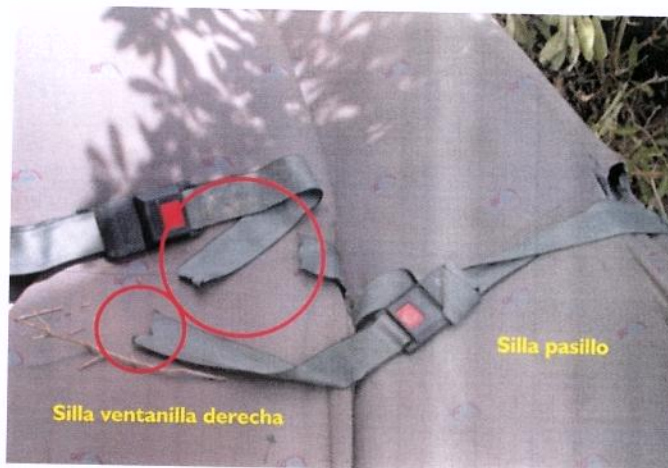
Foto de la forma en que fallaron por sobre esfuerzo los cinturones
