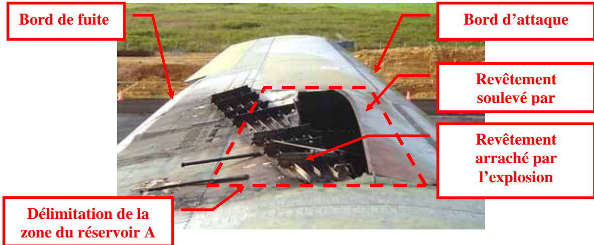
Extrados de l'aile gauche Les dégâts sont circonscrits au réservoir A
