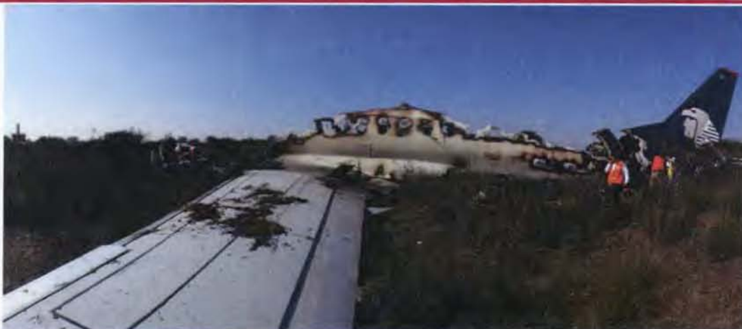
1.3.4. Vista desde la semiala izquierda sin daños, contenía combustible el tanque, el empenaje sin daños por fuego
