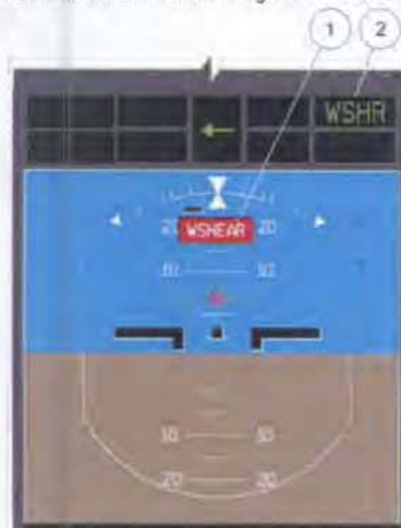
1.6.5.2.1. Imagen proporcionada por el Estado de fabricación (Embraer S. A.) para una mejor comprensión de la indicación de windshear (WSHEAR), y el color (ámbar = caution, red = warning)
