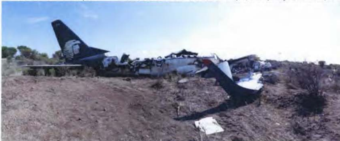
1.3.5. Vista desde la semiala derecha con daños y sin combustible en el tanque, el empenaje sin daños por fuego
