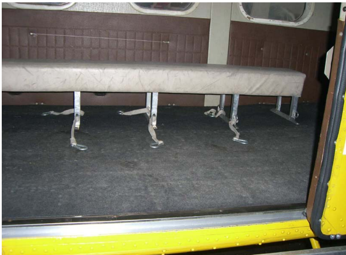
Рис. 11. Скамейка вдоль правого борта с ремнями безопасности на самолете SMG-92
