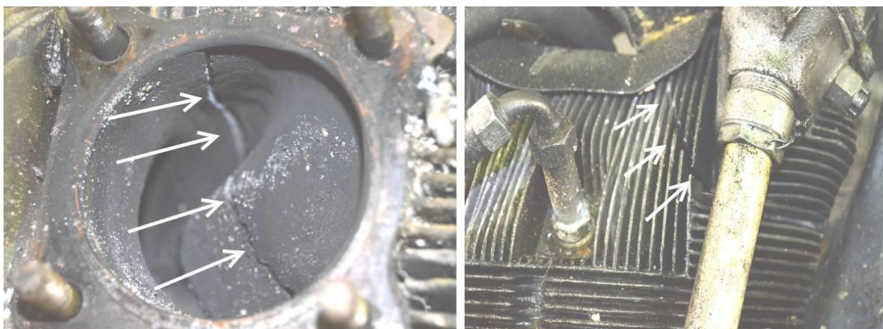
Рис. 7. Вид трещины в головке цилиндра № 1 (показана стрелками)
