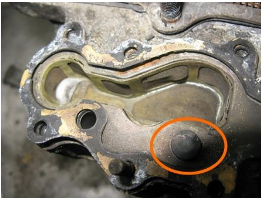
Рис. 9. Вид резиновой заглушки на ВАК двигателя АШ62-ИР № 16509153
