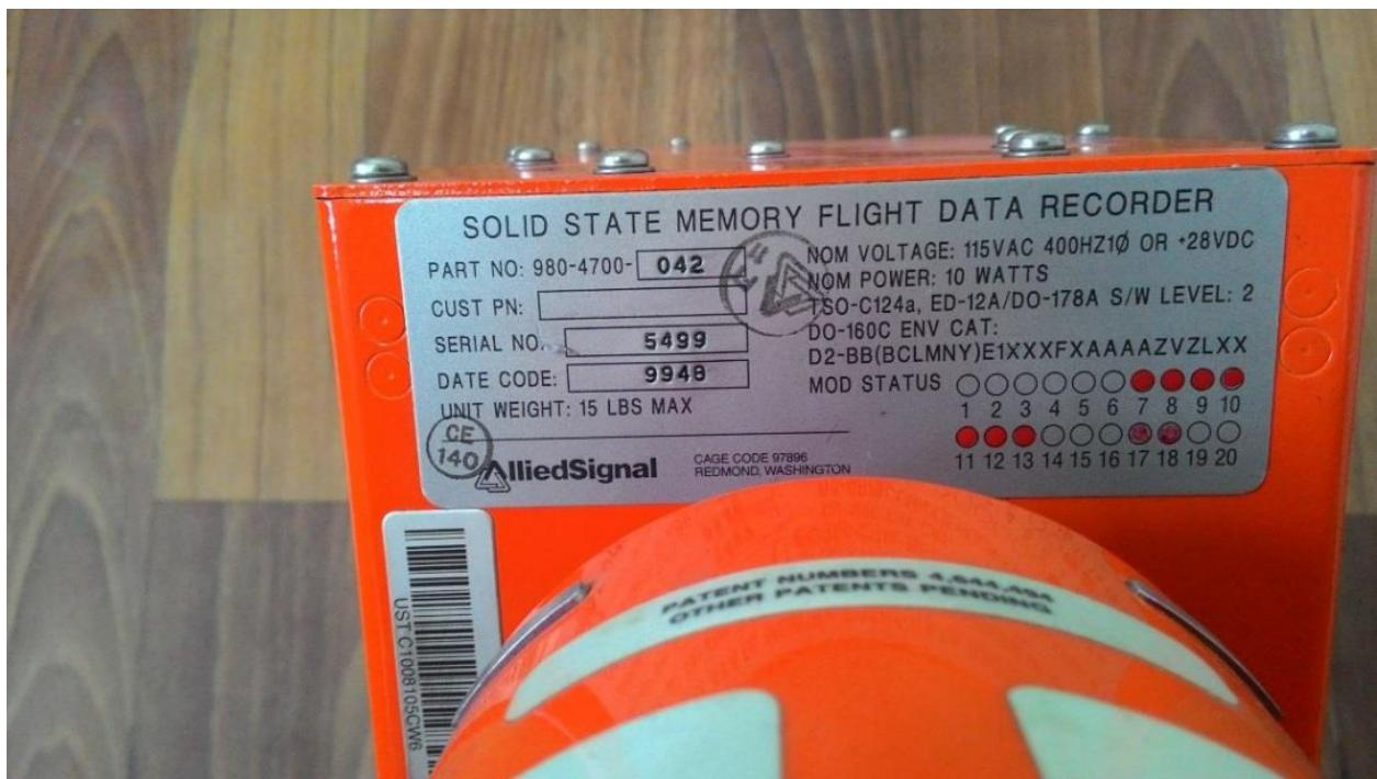
**Рисунок 11 Шильдик с данными FDR**
