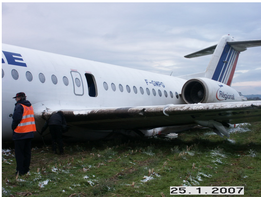
Issue de secours latérale arrière gauche
