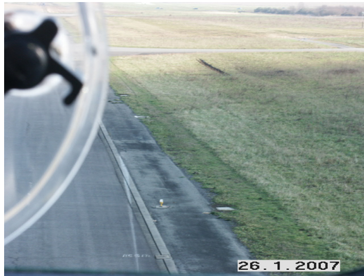
Traces laissées par le saumon gauche et le train d'atterrissage droit
