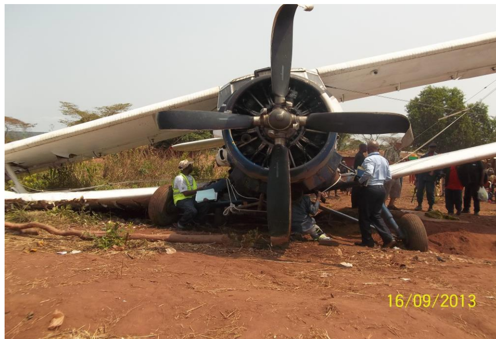
Fig.8. Pâles de l'hélice tordues.
