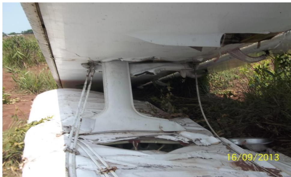
Fig.6. Cassure du câble de soutenance de l'aile droite haute et basse.
