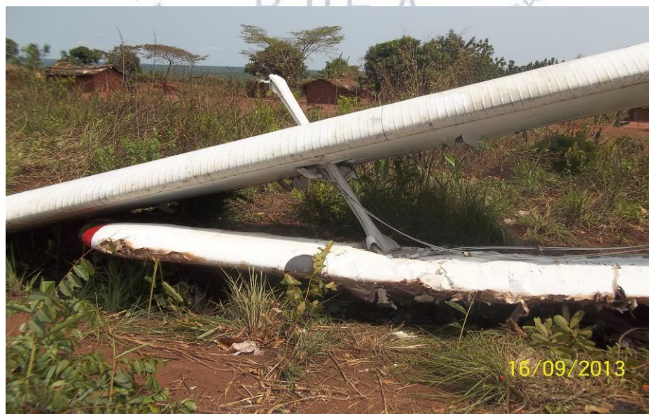
Fig.5. Aile droite sérieusement endommagée.
