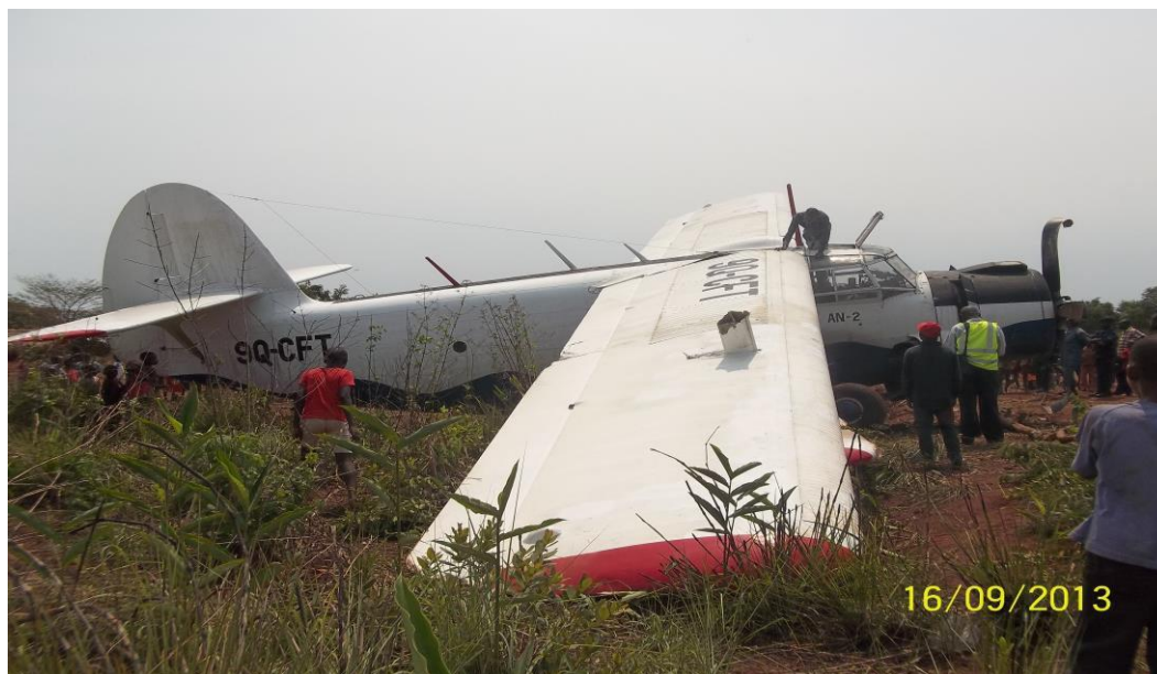
Fig.4. Aile droite haute percée.
