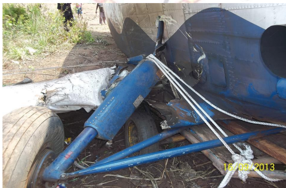
Fig.7. Train droit cassé et fuselage troué.
